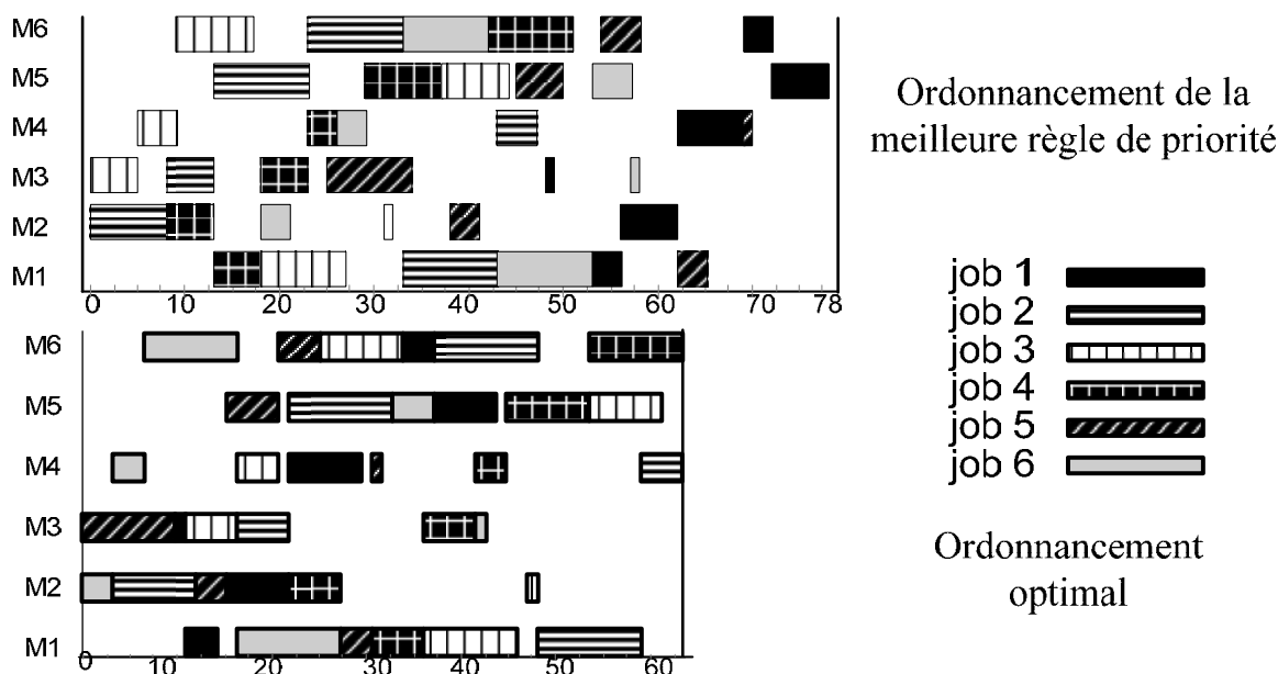
Figure 3-16. Diagramme de Gantt pour l'instance ft06_0_1
