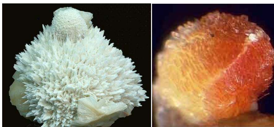
Figure 1 : Deux zéolithes naturelles : la mordénite et la ferrièreite
