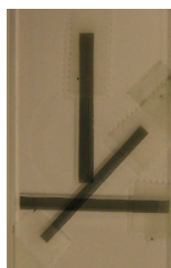
FIGURE 4.14 – Echantillon utilisé pour la validation en conditions imageantes. L'échantillon est constitué de trois bandes de polariseurs linéaires fixées sur une lame de microscope par de l'adhésif.
