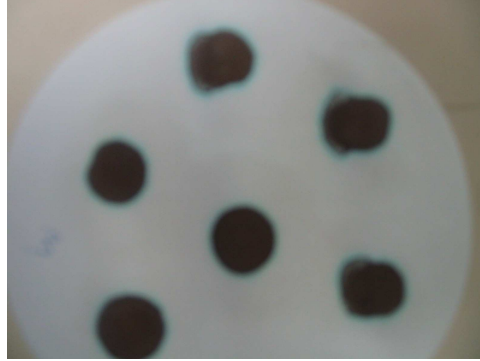
Photo 2-7 : Les gouttes centrales entourées d'une zone humide teintée.
