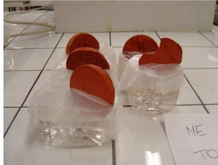
**Photo. 4-2 :** Test d'efflorescence
