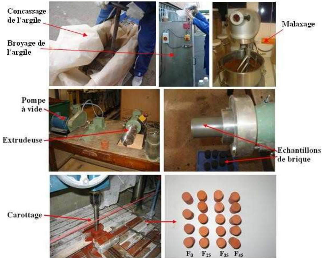
Fig.4-10 : Préparation en laboratoire des échantillons de brique
