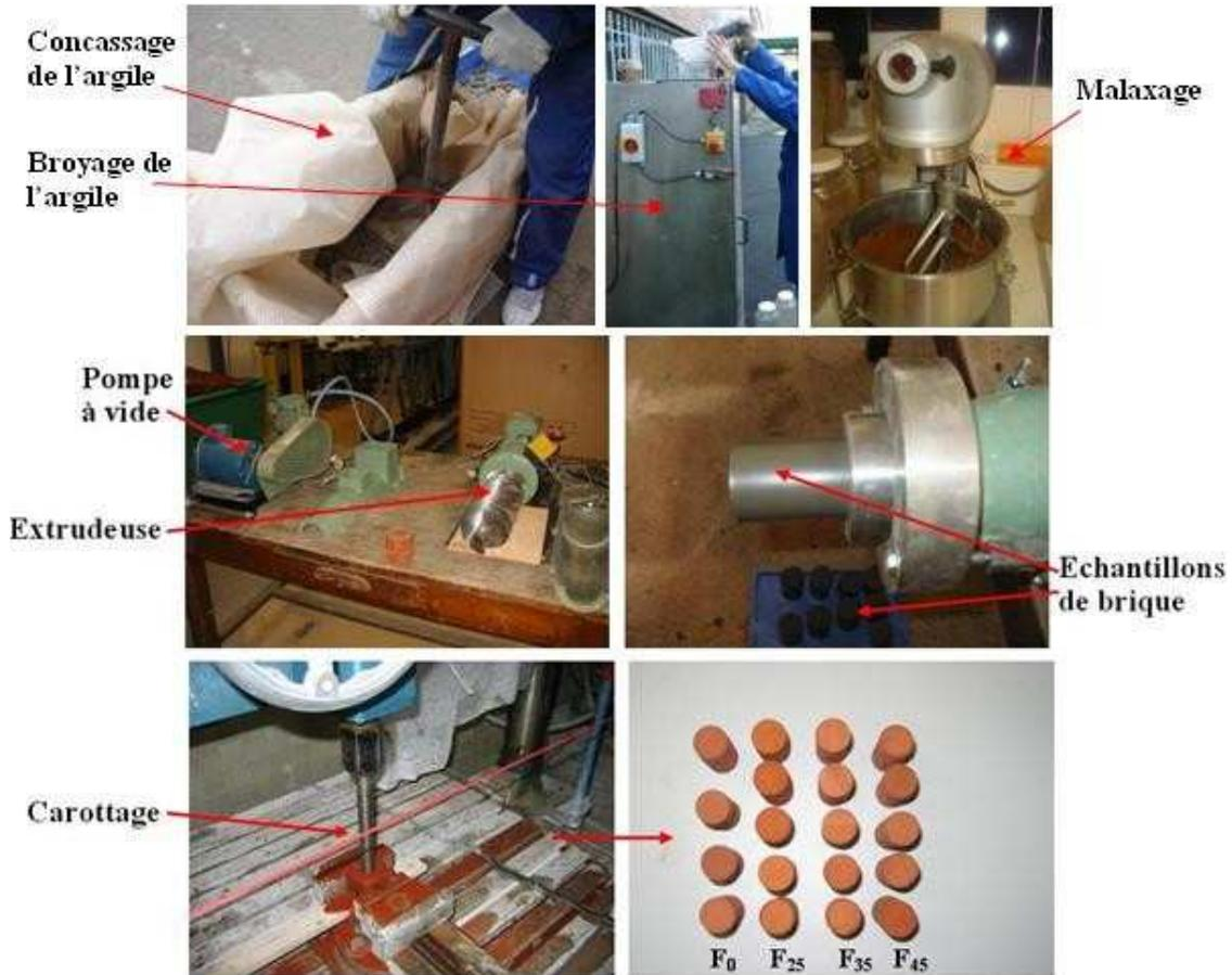
**Fig.4-10** : Préparation en laboratoire des échantillons de brique
