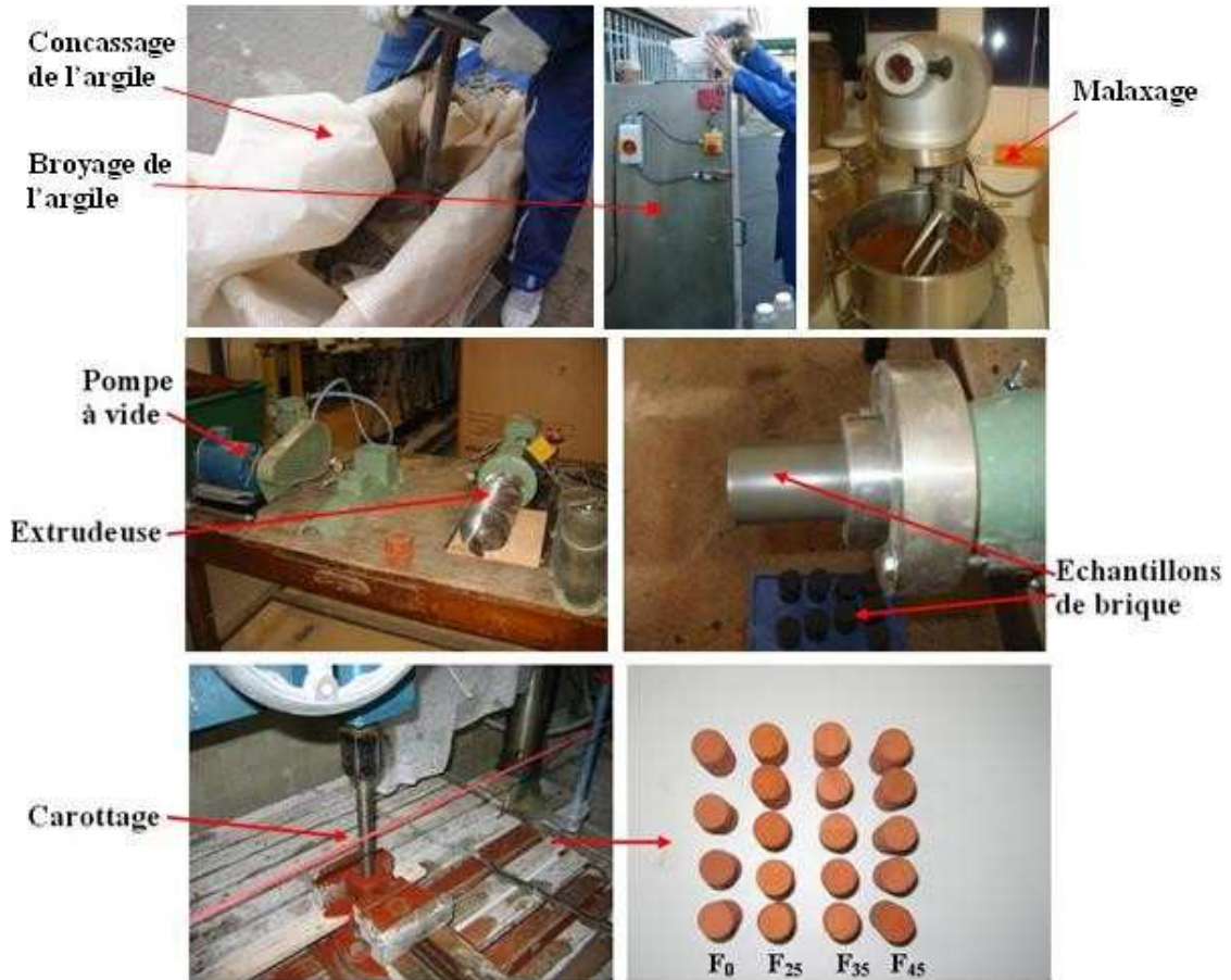
Fig.4-10 : Préparation en laboratoire des échantillons de brique
