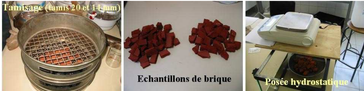
Fig. 5-2 : Préparation des échantillons et réalisation du test de porosité
