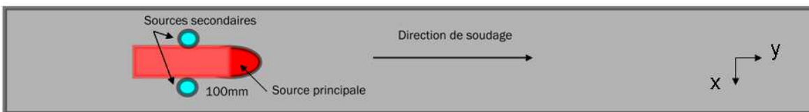
Figure 5.16 – Positionnement des sources secondaires dans le but de diminuer le taux de refroidissement dans la zone de solidification
