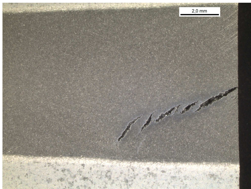
Figure 3.13 – Observation de la zone d'initiation de la fissuration, pour un échantillon d'épaisseur 3 mm
