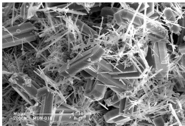
Figure 24 : Cliché MEB montrant les morphologies en aiguilles du matériau IM-20 et les prismes typique d'une zéolithe de topologie MFI (échantillon MDN-016) (grossissement 5 000x).
