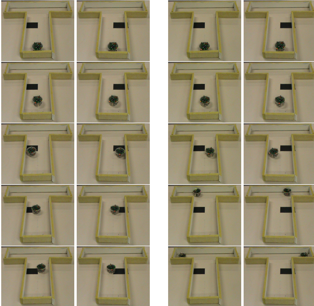
FIGURE 4.11 – A gauche, comportement typique évolué avec l’approche de référence : le comportement transféré est inefficace et le robot ne résout pas la tâche, car incapable d’éviter les murs. A droite, comportement typique obtenu avec l’approche par transférabilité. Le robot se comporte de manière optimale dans les deux cas de tests. Pour chaque couple de colonnes, la colonne de gauche (resp. de droite) correspondant au cas de test où la zone de couleur est à gauche (resp. à droite).
