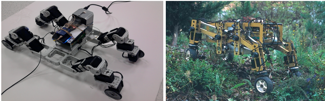
FIGURE 4.13 – A gauche, le robot utilisé pour cette application, construit d’après le robot Hylos (photographie de droite).
