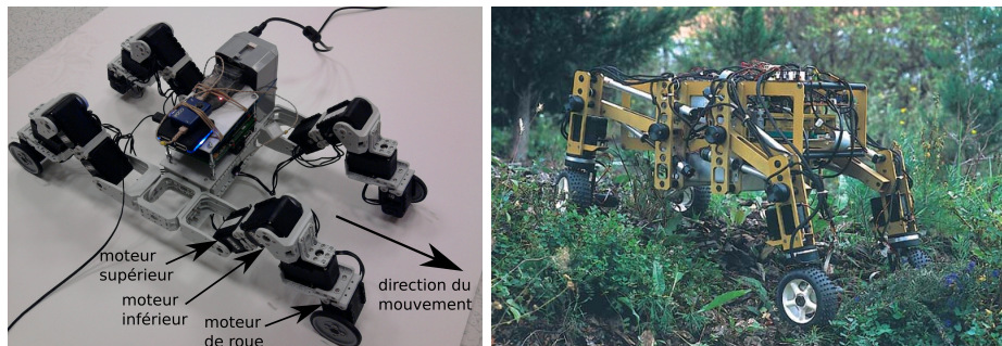
FIGURE 6.1 – A gauche, robot quadrupède à locomotion hybride roues-pattes utilisé dans les expériences (12 degrés de liberté), construit d'après le robot Hylos (à droite).
