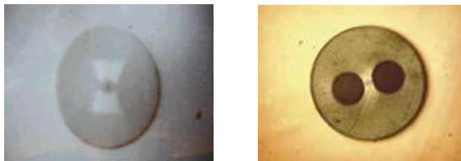
FIG. 3.2 – Vue en coupe de deux types de fibre optique à maintien de polarisation. A gauche : Fibre Bowtie ; A droite : fibre Panda
