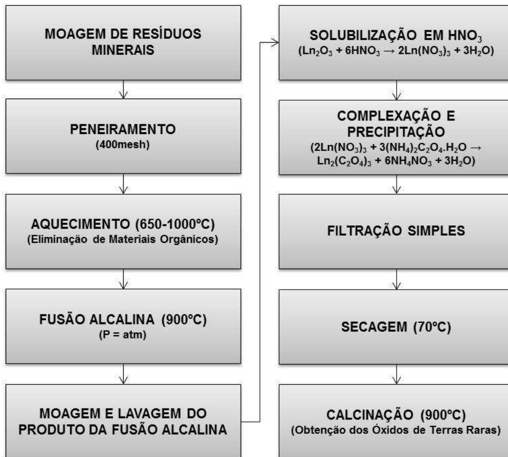
Figura 3.4 - Fluxograma do processo de obtenção dos pós dos óxidos de terras raras.
