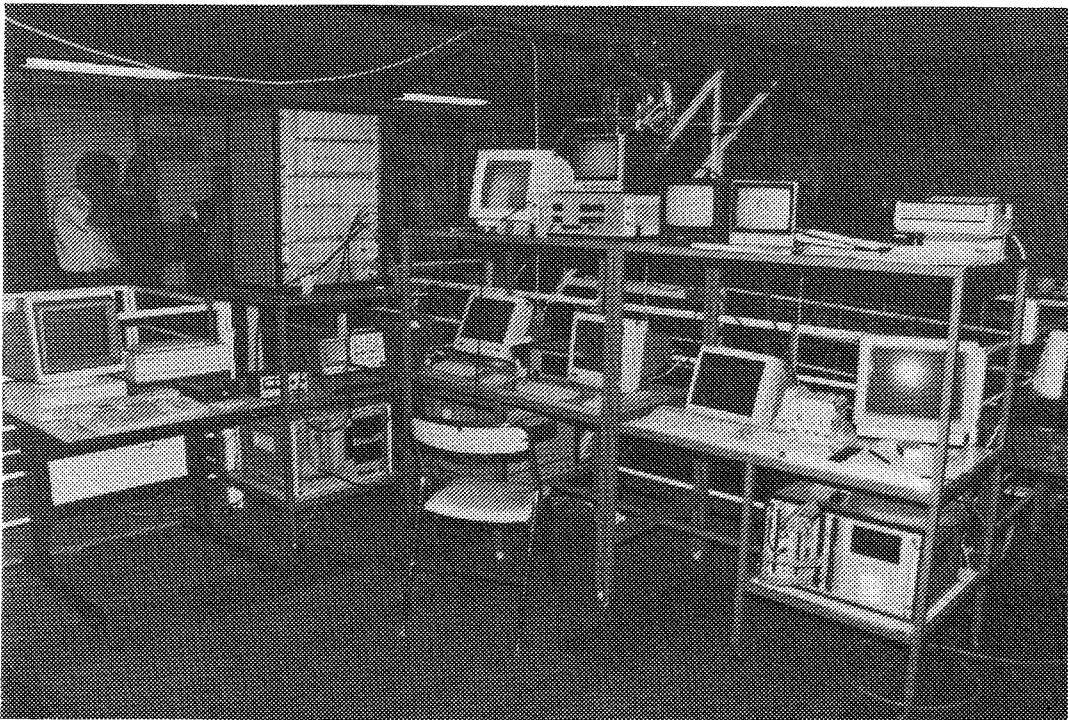
Photographies 6.1 Implantation du montage opto-mécanique de l'expérience COME-ON au foyer coudé du télescope de 1,5 m de l'OHP (en haut). En bas, consoles de contrôle de l'expérience. De gauche à droite : console et ordinateur de contrôle de l'analyseur de surface d'onde, calculateur de surface d'onde, console de contrôle de la commande de l'asservissement et console de contrôle du graphisme, ordinateur de commande, console et ordinateur de contrôle de la caméra infrarouge.
