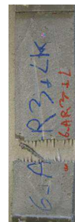
Figure 156 : « P6(10)/VAR(3)+latex » après rupture
