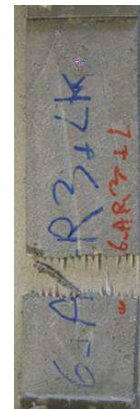
c) TRC au taux de renfort largement « sur-critique 2 » préimprégné par latex « P6(10)/VAR(3)+latex »
