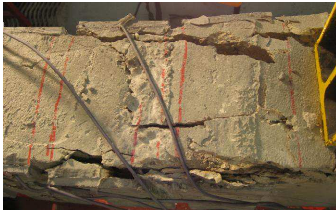
Figure 216 : Poutre « R30-B-FI-P-TRC(5) » après rupture
