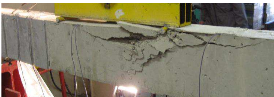
Figure 217 : Poutre « R30-B-FI-P-TRC(10) » après rupture
