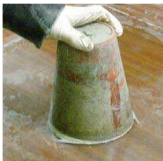
Figure 141 : Essai permettant de mesurer l'ouvrabilité du mortier « E »
