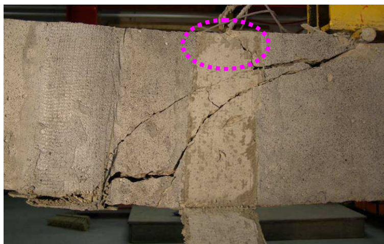
Figure 221: Poutre « R40-B-U-Is-TRC(5) » après rupture
