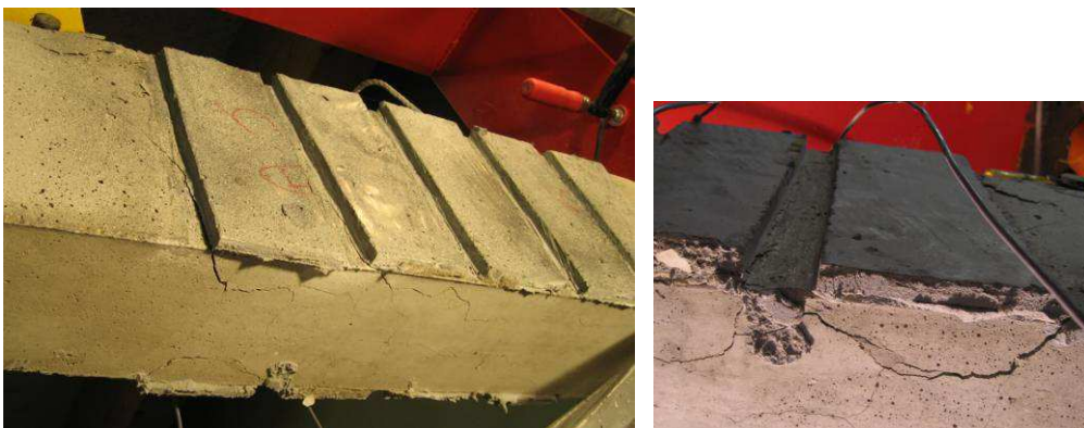
Figure 265 : Illustration de la poutre « R30-B-FI-P-TRC(10) » après rupture
