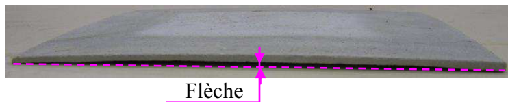
Figure 76 : Illustration de la flèche qui traduit le voilement d'une plaque de TRC
