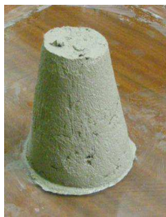
Figure 141 : Essai permettant de mesurer l'ouvrabilité du mortier « E »
