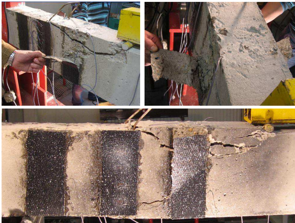
Figure 218 : Poutre « R30-B-U-Is-CFRP(0,5) » après rupture
