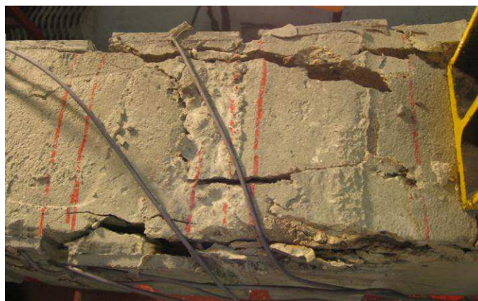
Figure 232 : Poutre « R30-B-FI-P-TRC(5) » après rupture (face supérieure)
