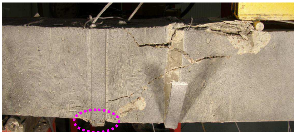
Figure 219 : Poutre « R30-B-U-Is-TRC(5) » après rupture
