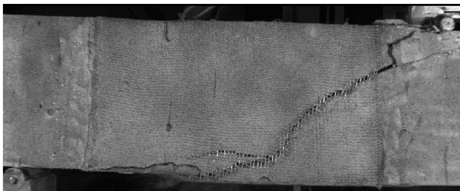
Figure 224 : Poutre « R40-C-U-Is-TRC(2) » après rupture
