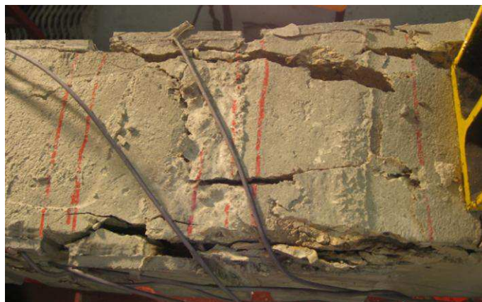
Figure 216 : Poutre « R30-B-FI-P-TRC(5) » après rupture
