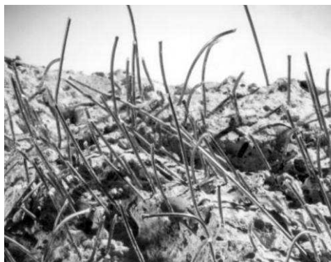
Figure 9 : Surface de rupture d'un composite fibre d'acier-ciment
