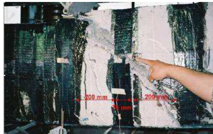
Figure 187 : Illustration d'une rupture du composite
