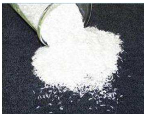
Figure 8 : Fibres de verre utilisées dans les composites fibres-ciment
