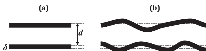
Figure 2. 4 : Représentation schématique de phases lamellaires à (a) bicouches rigides et (b) bicouches flexibles. Sur la Figure 2. 4. b, on peut visualiser l'excès de surface dû aux ondulations des bicouches.
