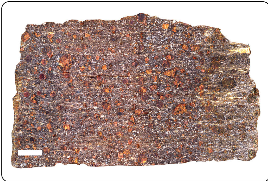
Figure 100 : grenatites à kyanite de Saugère. Type pétrographique à grain fin. La barre d'échelle mesure 1 cm
