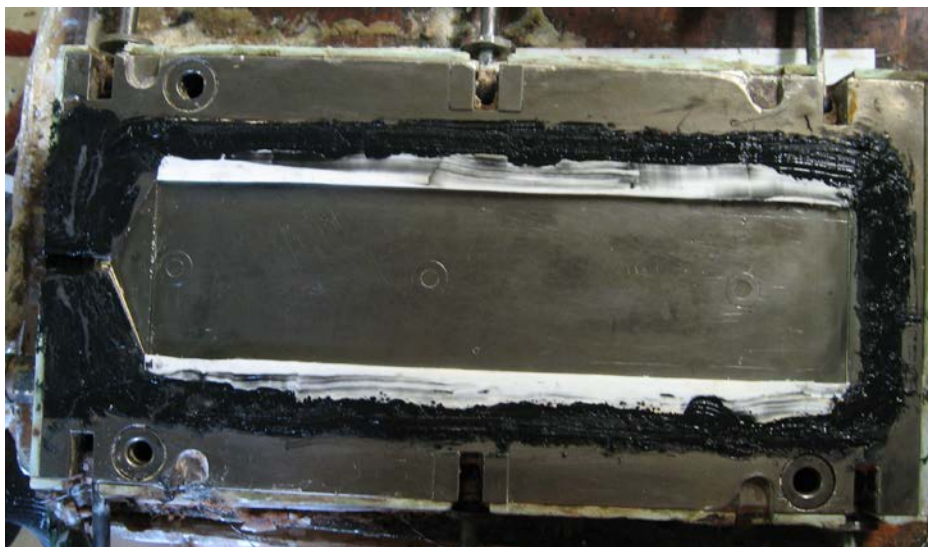
Figure 65 – Vue de la face intérieure de la partie inférieure du moule avec joints en PA-6.
