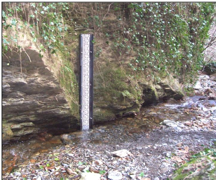
Photographie 2: Station limnimétrique à l'exutoire du Crébadès
