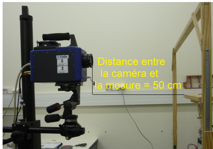
FIGURE 6.3 – Distance entre la caméra et la mesure.
