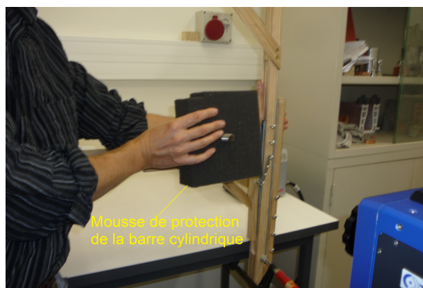
FIGURE 6.6 – Utilisation de la mousse pour la position horizontale. On aperçoit la barre au centre de la mousse.
