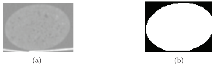
Figure III.5 : Traitement d'image du cône : image scanner (a) et résultat de la segmentation (b).
