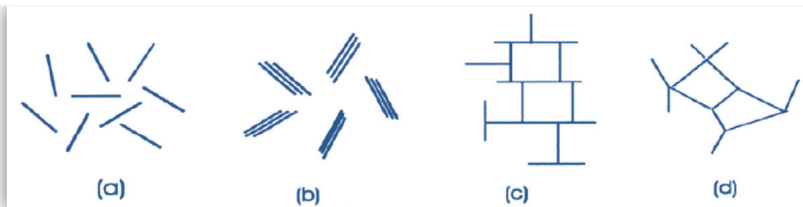
Figure 10 Modes d'associations supposés des feuillets de montmorillonite en suspension selon la théorie de Van Olphen (1964): (a) dispersion, (b) agrégation face-face, (c) association bord-face, (d) association bord-bord
