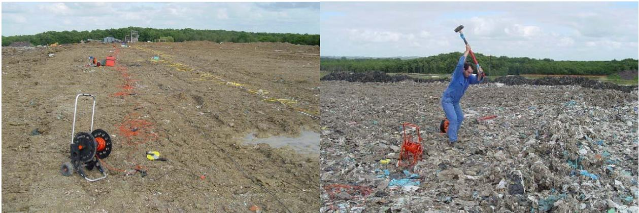
**Figure 5.58** (a) Vue des profils résistifs et sismiques implantés sur le site de Cognac (b) Illustration du mode d'impact sismique
