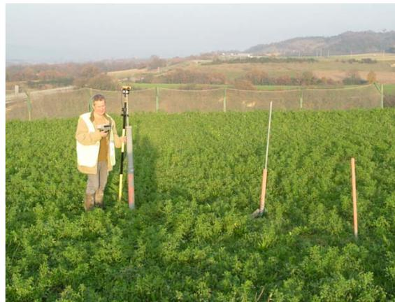
**Figure 5.16** Instrumentation combinée : plaque enterrée (PE), plaque télescopique (PT) et plaque de surface (PS) (a) Vue en fin d'exploitation (b) Relevé topographique 18 mois plus tard
