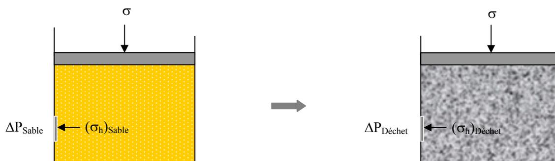
**Figure 4.19** Principe de comparaison de la pression latérale dans le cas d'essais de calibration et d'essais sur déchets.
