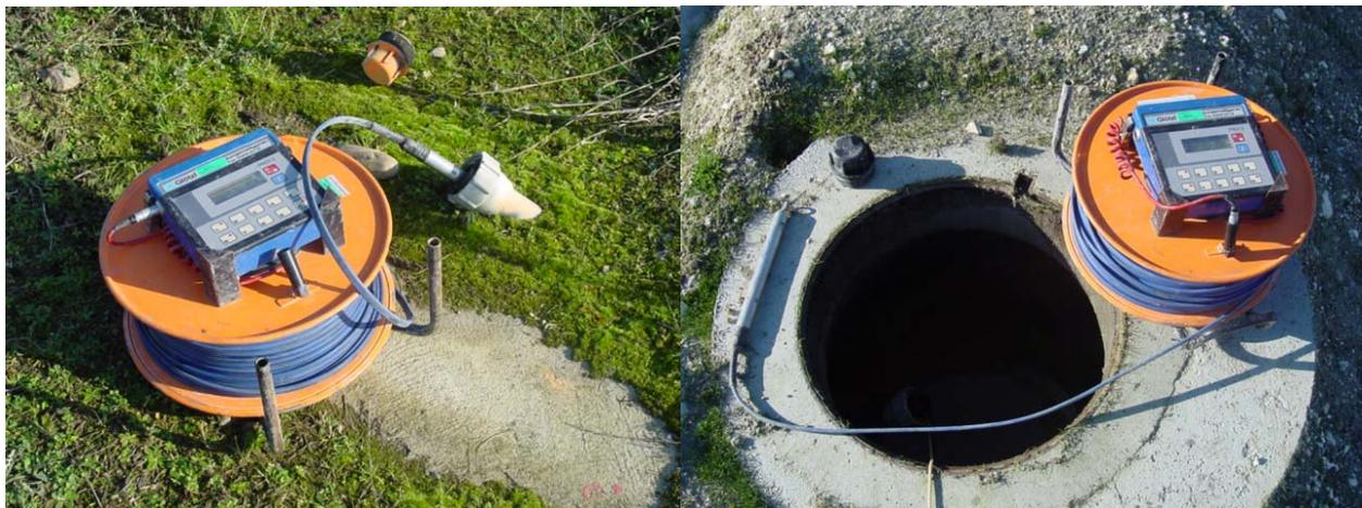
**Figure 5.38** Illustration de l'entrée des profilomètres de Montech (a) et Lapouyade (b) au cours de l'introduction de la sonde gravimétrique
