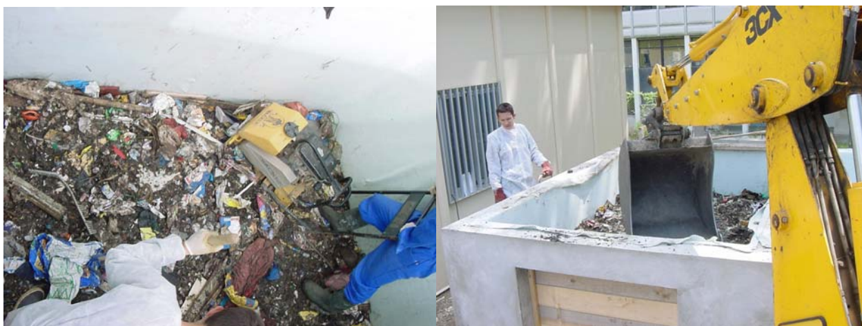
Figure 4.32 Compactage des déchets à la vibreuse à main et au godet (Araujo Morais, 2003)
