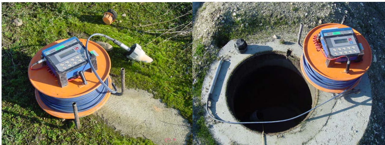
Figure 5.38 Illustration de l'entrée des profilomètres de Montech (a) et Lapouyade (b) au cours de l'introduction de la sonde gravimétrique
