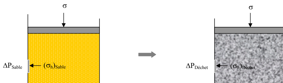
Figure 4.19 Principe de comparaison de la pression latérale dans le cas d'essais de calibration et d'essais sur déchets.
