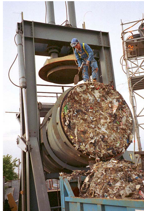
Figure 4.2 Cellule de compression Pitsea (Projet Sunrise, www.soton.ac.uk/~sunrise )
