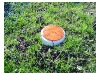
Figure 5.28 (a) Plaques de surface utilisées sur le CSD de Montréal (Moreau, 2001) (b) Exemples de bornes ancrées dans la couverture en terre végétale (CSD de Torcy et Lapouyade)
