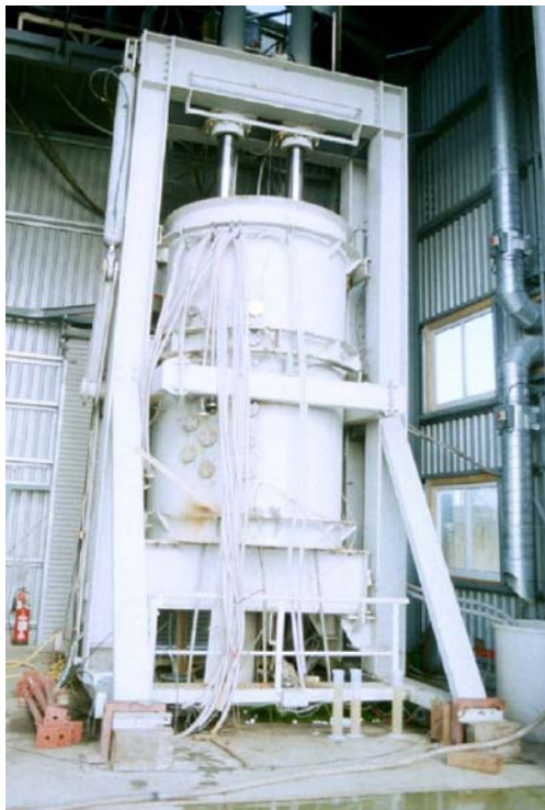
Figure 4.2 Cellule de compression Pitsea (Projet Sunrise, www.soton.ac.uk/~sunrise )
