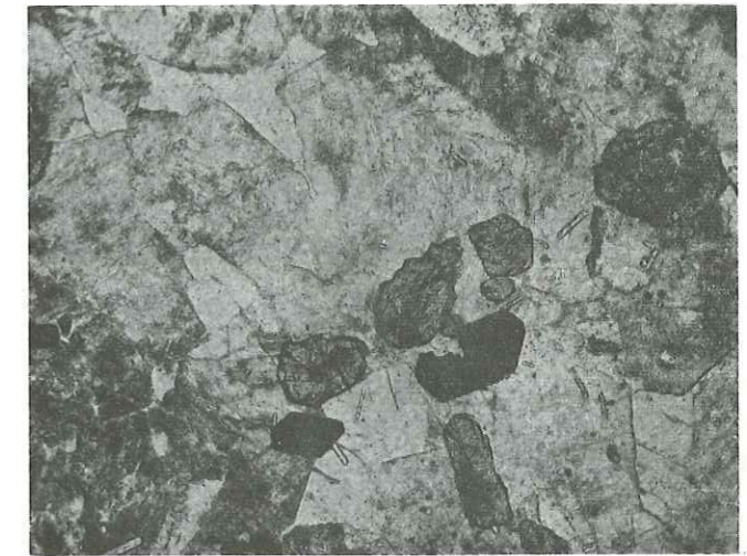
Photo28 LM La V. 10 . Granite sub alcalin à pyroxène (diopside) de La Venada L.P. x 20 .
