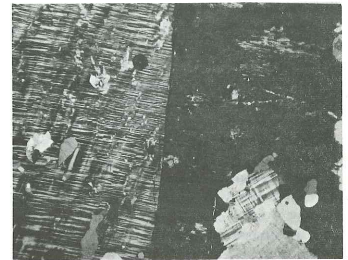
Photo26 LM 22 c 16 . Porphyroblaste de microcline dans granite subalcalin (Granite de Matape) . L.P. x 10 .
