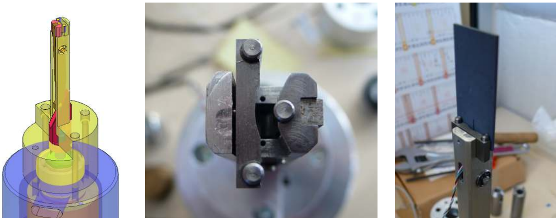
Figure 2.9: Prototype de double-torsion pour tomographie X : dessin de conception, vue de dessus sans échantillon, vue de côté avec échantillon
