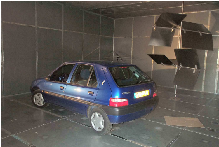
FIG. 1.6: Automobile placée dans la CRBM du LASMEA.
