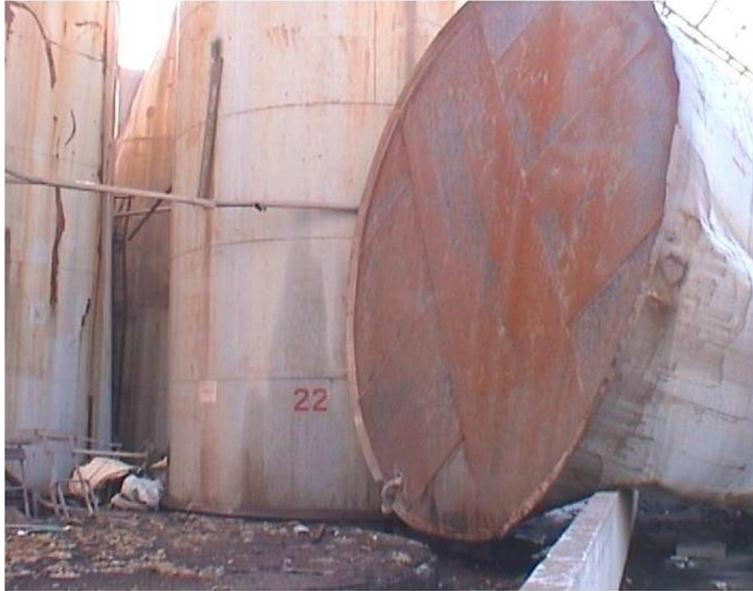
FIGURE 2.1 – Renversement d'un réservoir vide (AZF 2001).
