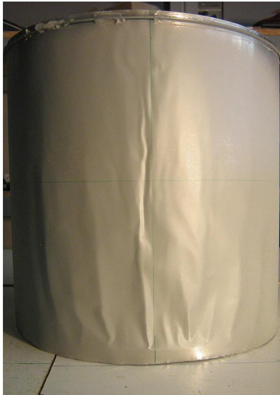
FIGURE 4.24 – Réponse mécanique du réservoir 1 avec un rayon de bulle  $R_o=6$  cm et  $d=14$  cm.
