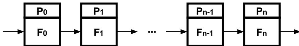
FIG. 5.4 – Graphe de processus communicants du squelette pipeline
