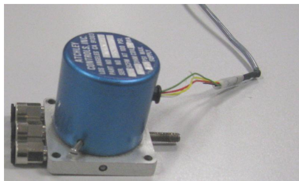
Fig. 3.12. Atchley 200PN-176 servovalve
