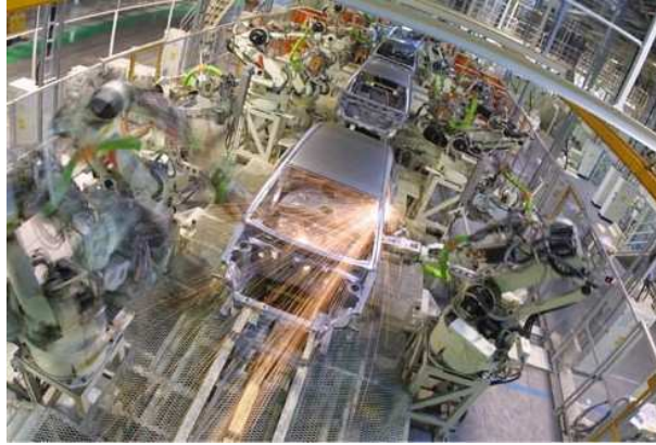
Figure 1 : Automate réalisant la soudure sur les carrosseries de voiture, Industrie « Toyota ».
