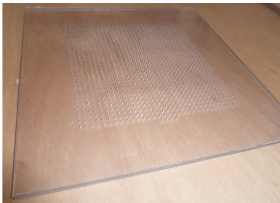
Figure III. 6 : Vue d'une plaque à trous utilisée pour reproduire le comportement aéraulique des fuites.
