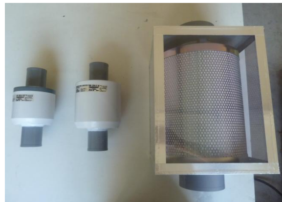
Figure III. 7 : Filtres de boîtes à gants utilisés pour reproduire le comportement aéraulique des filtres THE.
