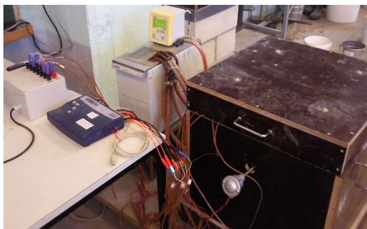
Figure 3.3 : Calorimètre adiabatique développé au service BATir de l'ULB.
