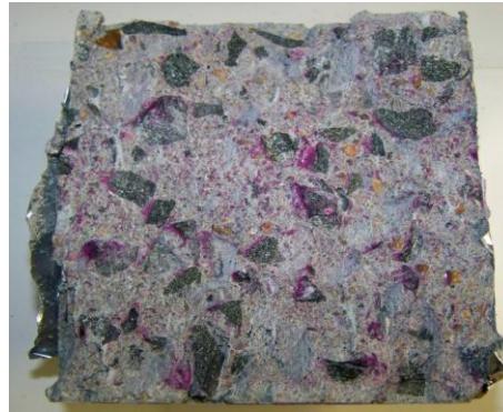
Figure 4.21 : Section d'un échantillon du béton CV 50 Test pulvérisée de phénolphtaléine après 14 jours dans l'enceinte de carbonatation accélérée — Conservation « Air ».
