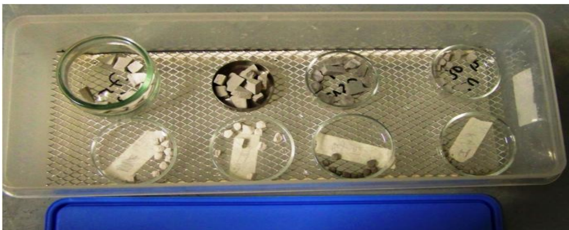
Figure 3.2 : Échantillons de pâte de ciment pour la détermination des isothermes de désorption.
