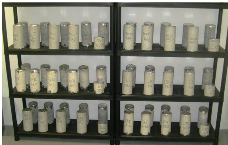
Figure 3.5 : Éprouvettes 11X22 cm en cours de carbonatation en conditions naturelles en laboratoire.
