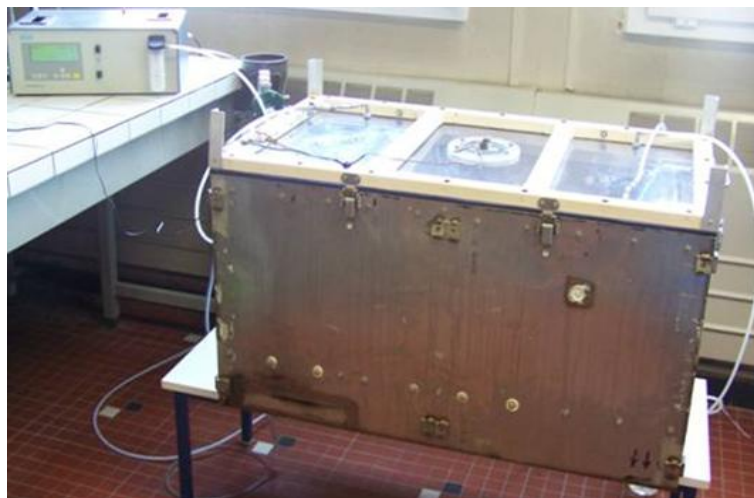
Figure 3.4 : Enceinte de carbonatation en conditions accélérées.
