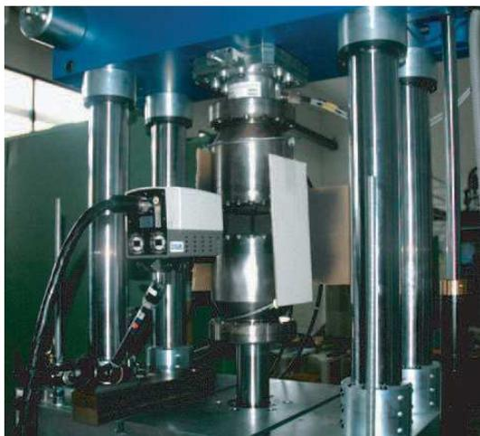
*Figure 5.15: Dispositif expérimental pour l'essai d'auto-échauffement avec utilisation d'une caméra infrarouge (lors de l'essai, d'autres protections sont mises en place autour de la caméra et de l'éprouvette).*
