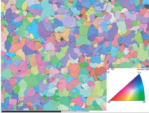
Figure 3.5: Orientation cristalline des grains d'une zone d'étude du grade B vierge de toute sollicitation.
