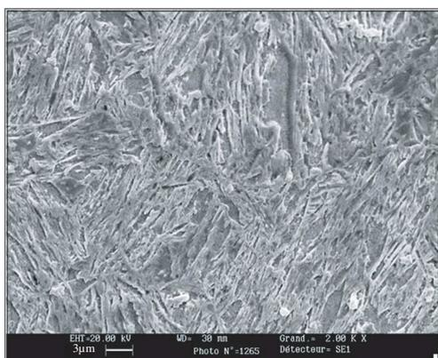
Figure 2.12: Microstructure d'un acier Usibor
