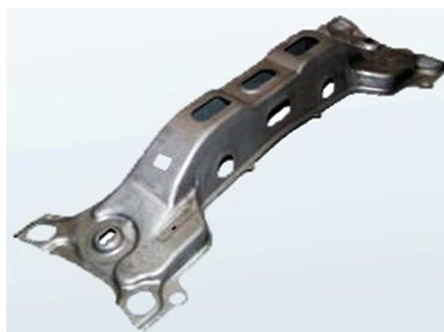
Figure 2.3: Traverse arrière en HSLA.
