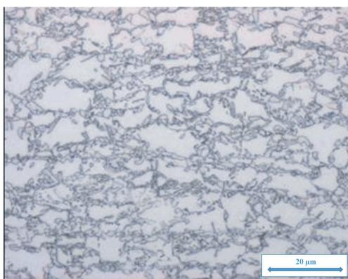
Figure 2.10: Microstructure d'un acier TRIP.
