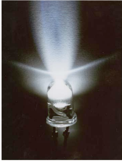
Figure 1-20 : Photographie d'une diode blanche réalisée à partir d'une diode bleue et de YAG :Ce
