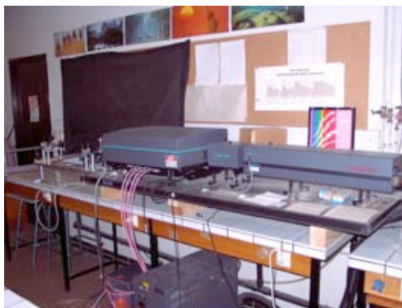
Figure 5-14 : Laser à colorant pompé par un laser YAG : Nd 3+ à impulsions
