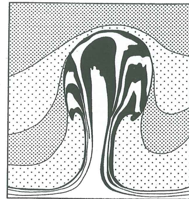
Figure I-5 Schéma d'un diapir de sel qui est en train de traverser les couches sus-jacentes [Weijermars, 1993]. En général, il a la forme d'un champignon. Sur le schéma, les surfaces noires représentent les différentes couches de sel.
