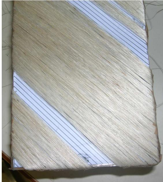
FIG. 4.12: Enroulement des fibres sur les supports en verre.
