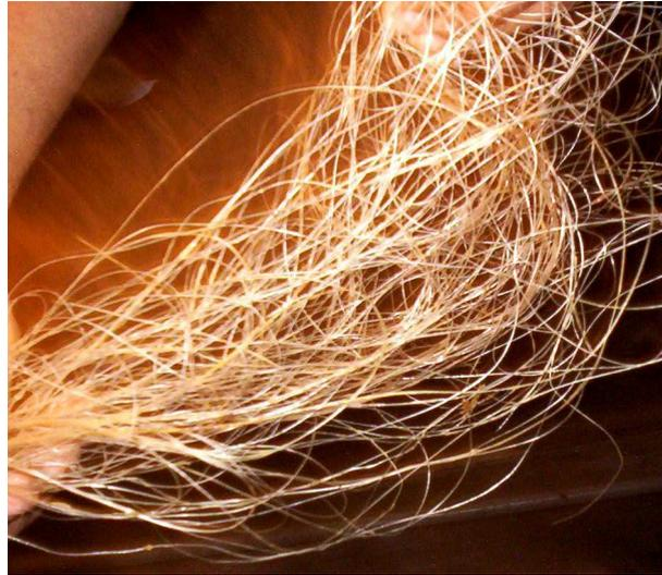
FIG. 3.4: Fibres de RC extraites par rouissage à l'eau
