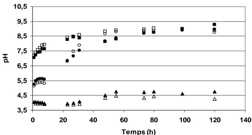
Figure 172 : Suivi du pH des échantillons des cinétiques de biodégradation de la mésotrione 1 mM par la souche *Bacillus* sp. 3B6 en absence d'argile (■) et le témoin cellules (□), en présence de K10 dans le rapport 1/10 (●) et le témoin cellules (○), en présence de K10 dans le rapport 1/3 (▲) et le témoin cellules (△)
