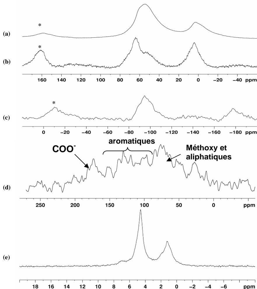
Figure 59 : Spectres de RMN MAS du sol de Limagne. (a)  $^{27}\text{Al}$  MAS  $\nu_r = 12$  kHz, impulsion rf 1.6  $\mu\text{s}$ . (b) idem, impulsion rf 4,2  $\mu\text{s}$ . (c)  $^{29}\text{Si}$  MAS  $\nu_r = 5$  kHz. (d)  $^{13}\text{C}$  CP-MAS  $\nu_r = 12$  kHz. (e)  $^1\text{H}$  MAS. \* bandes de rotation.
