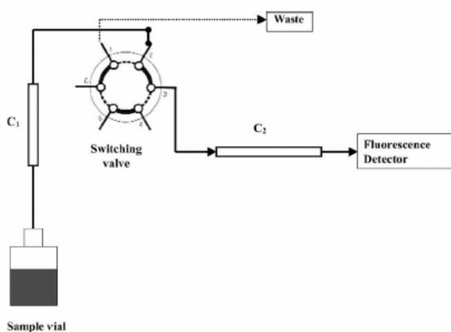
**Figure 54 : Montage en série de deux colonnes analytiques ( $\text{C}_1$  et  $\text{C}_2$ ) séparées par une vanne.  $\text{C}_1$  sépare le Fmoc-OH qui est dirigé vers la poubelle et le reste de la fraction de l'échantillon à analyser est envoyé vers  $\text{C}_2$  (d'après Nedelkoska et Low, 2004).**
