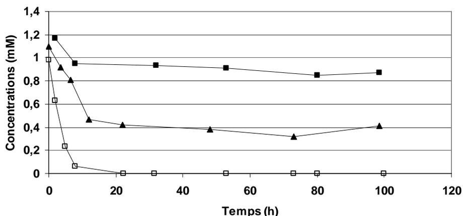
**Figure 116 : Cinétiques de biodégradation de la mésotrione (1 mM) dans le tampon borate, pH 9, contrôlées par RMN <sup>1</sup>H (■), par HPLC (▲) et cinétique de biodégradation de la mésotrione dans l'eau de Volvic (□).**
