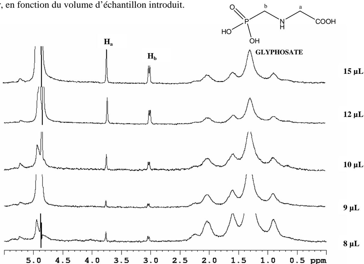
Figure 158 : Spectres  $^1\text{H}$  HR-MAS du glyphosate 4 mM
