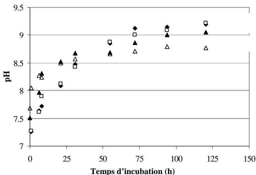
**Figure 112 : Suivi du pH des surnageants prélevés lors de biodégradation de la mésotrione : 1 mM (□), 5 mM (▲), 10 mM (△) et dans la culture témoin sans mésotrione (◆).**
