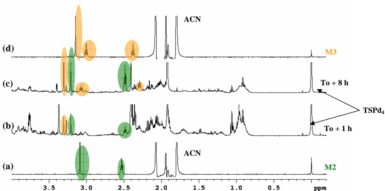
**Figure 77 :** Spectres RMN  $^1\text{H}$  (zone des aliphatiques) de M2 (a) et M3 (d) obtenus par LC/RMN, comparés aux spectres des milieux d'incubation d'une cinétique de biodégradation de la mésotrione 5mM (b et c).
