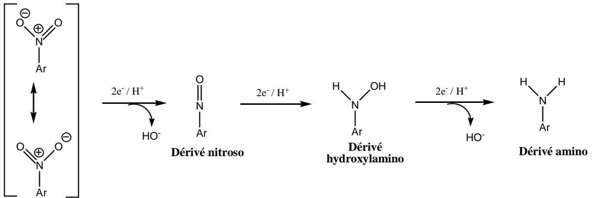
**Figure 33 : Mécanisme de réduction du groupement nitro par une réductase de classe I (Esteve-Nunez *et al.*, 2001)**
