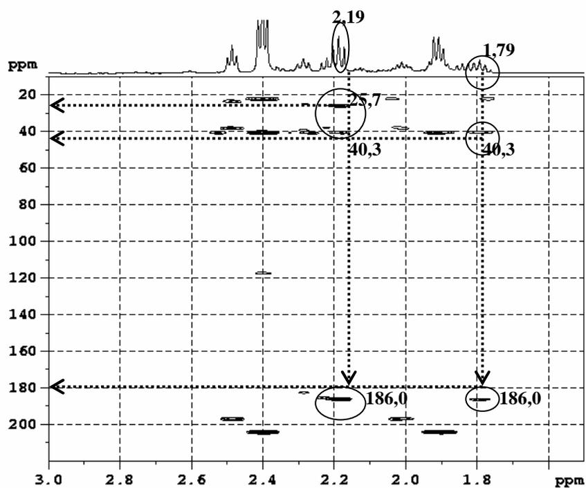
Figure 105 : HMBC  $^1\text{H}$ - $^{13}\text{C}$  d'un échantillon d'une cinétique de biodégradation de la mésotrione à 10 mM (To + 8 h)
