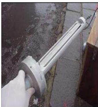
**Figure 64 : Impacteur servant à collecter l'eau de condensation des nuages**
