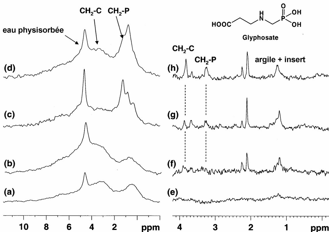
**Figure 164 :** Spectres  $^1\text{H}$  MAS du glyphosate adsorbé sur la montmorillonite KSF pour un rapport solide/liquide de 1/200. Spectres d'écho de Hahn enregistrés sur des échantillons secs : (a) KSF pure, (b-d) après adsorption du glyphosate, (e-h) spectres HR-MAS obtenus après hydratation (200 % w/w) (fréquence de rotation : 3 kHz). Du bas vers le haut :  $C_s = 0,12$  ;  $0,16$  et  $0,29$  mmol/g
