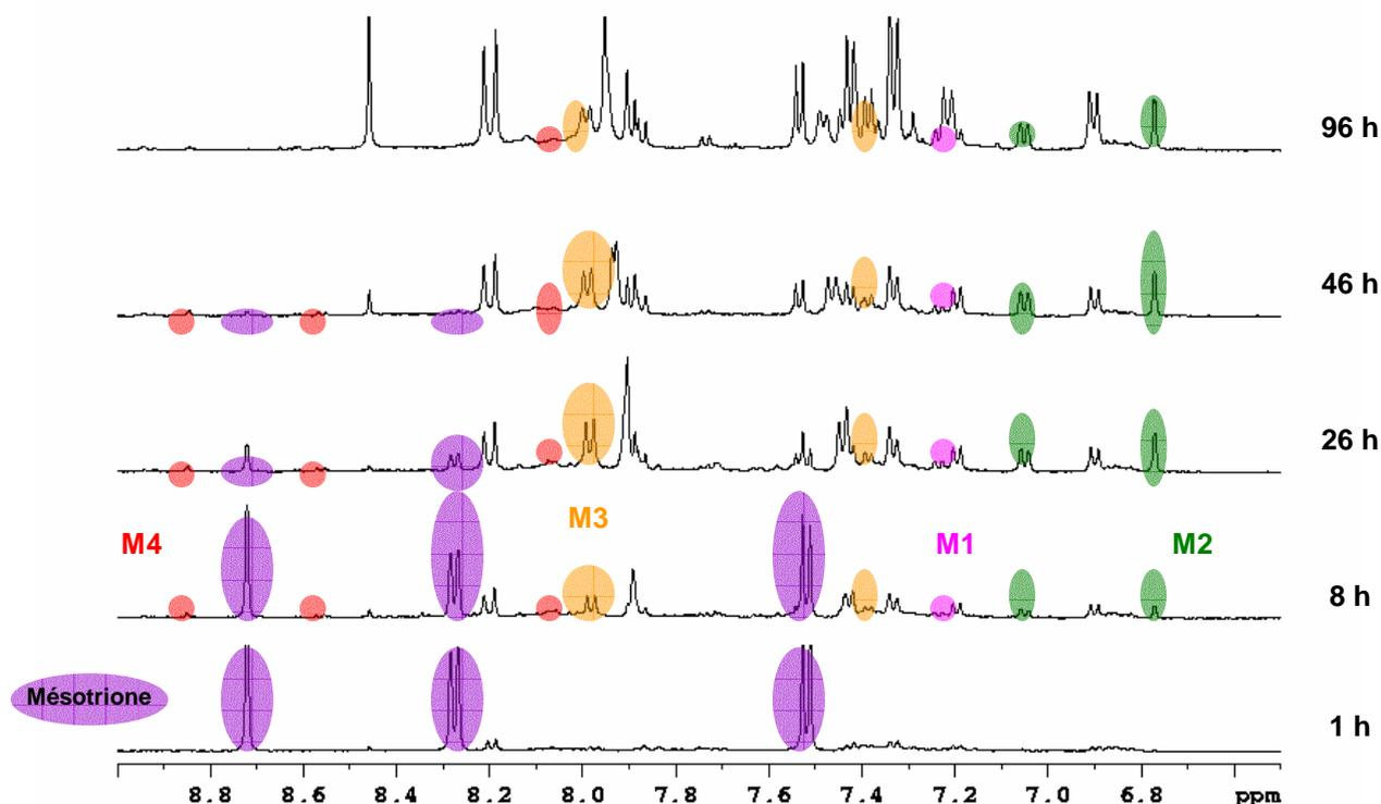
Figure 120 : Cinétiques de biodégradation de la mésotrione 1,5 mM, en anaérobiose, analysée par RMN <sup>1</sup>H
