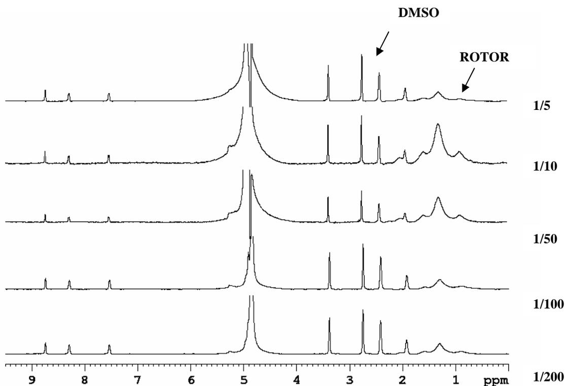
**Figure 160 : Spectres  $^1\text{H}$  HR-MAS de mise en contact de la mésotrione avec la kaolinite dans différents rapports solide/liquide**
