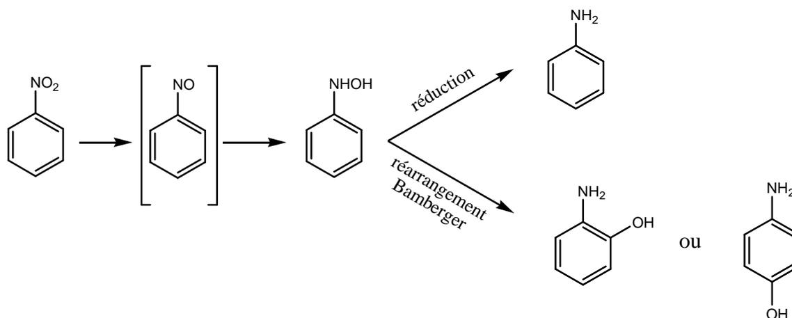
Figure 88 : Voies de biodégradation possibles des composés nitroaromatiques
