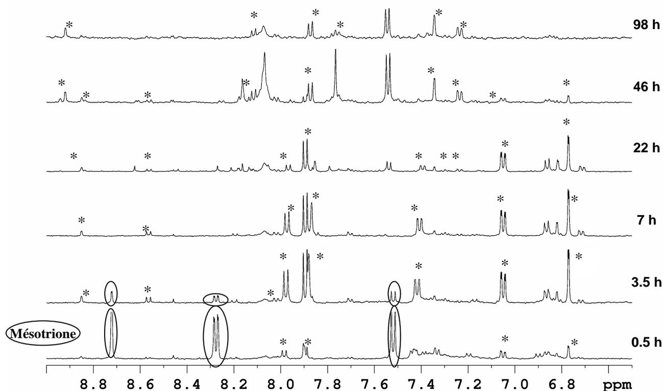
**Figure 69 :** Cinétique de biodégradation de la mésotrione 1 mM par la souche *Bacillus* sp. 3B6 analysée par RMN  $^1\text{H}$  *in situ*. Les astérisques correspondent à des signaux identifiés comme appartenant à des métabolites de la mésotrione (càd qui ne sont pas présents dans les témoins cellules seules).
