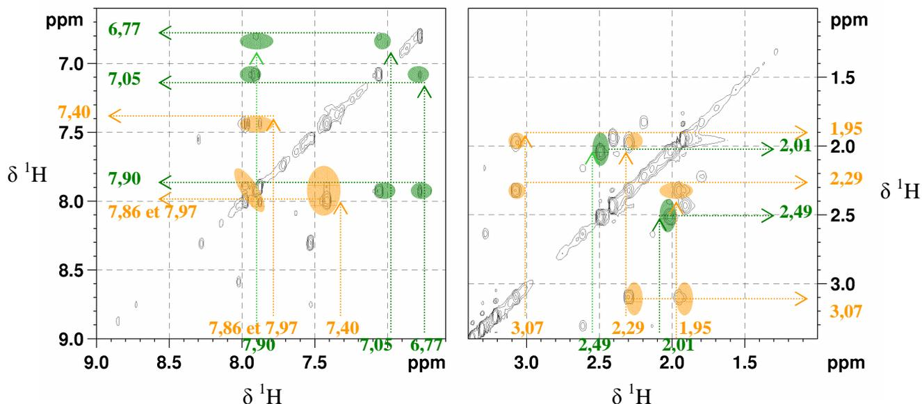
Figure 79 : Expérience TOCSY  $^1\text{H}$ - $^1\text{H}$  enregistrée sur un surnageant de biodégradation (To + 5 h) pour une concentration initiale en mésotrine de 5 mM. Durée du spin lock : 90 ms
