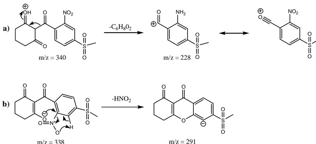
**Figure 73 : Proposition de mécanisme de fragmentation de la mésotrione en (+)ESI (a) et en (-)ESI (b)**
