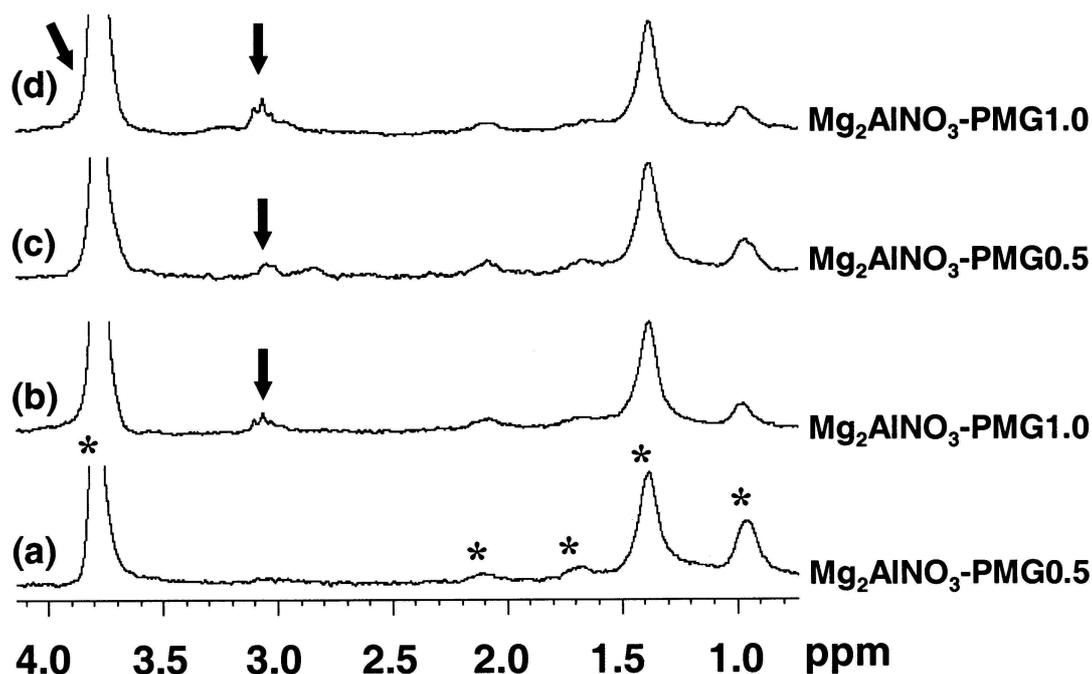
Figure 166 : Spectres de RMN  $^1\text{H}$  HR-MAS d'échantillons hydratés (200 % w/w) correspondant à deux points de l'isotherme (a)  $C_s = 0,5$  mmol/g et (b)  $C_s = 1,0$  mmol/g. Les spectres (c) et (d) correspondent aux mêmes échantillons hydratés par une solution de glyphosate en lieu et place d'eau. La flèche indique la position des signaux du glyphosate, les astérisques les résonances de la formulation
