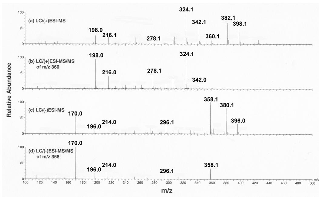
Figure 100 : Spectres LC/ESI-MS (a et c) et LC/ESI-MS/MS (b et d) du composé M5
