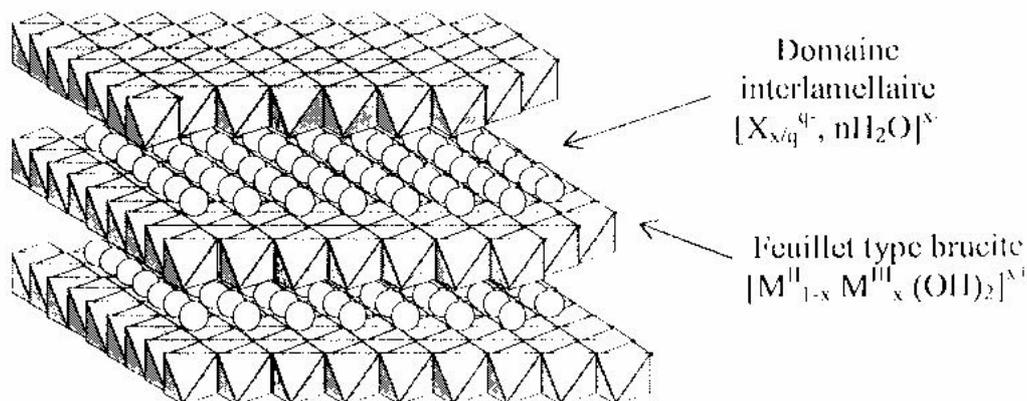
Figure 45 : Structure des argiles anioniques
