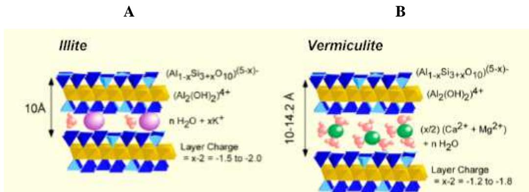
Figure 58 : Structures de l'illite (A) et de la vermiculite (B). Dans ces structures 10 à 20 % des ions  $\text{Al}^{3+}$  peuvent être substitués par des ions  $\text{Mg}^{2+}$  ou  $\text{Fe}^{2+}$  générant ainsi une charge négative
