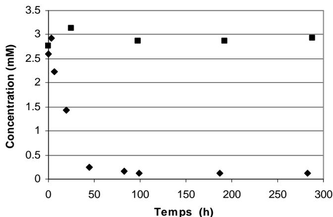
Figure 136 : Cinétiques de biodégradation du glyphosate (3 mM) par *Trametes versicolor* T2 (◆) et d'un témoin glyphosate sans cellules (■)
