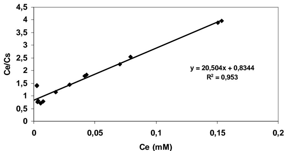
Figure 149 : Adsorption du glyphosate sur l'argile K10 dans le rapport solide/liquide 1/10 selon le modèle de Langmuir
