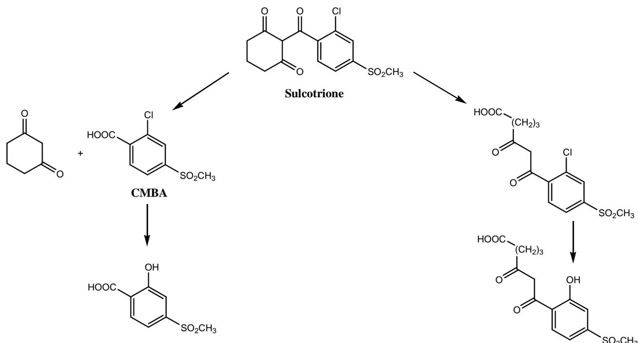
**Figure 16 : Photoproduits de la sulcotrione obtenus après irradiation sous lampes UV-B ( $\lambda_{\max} = 313 \text{ nm}$ ) (Chaabane *et al.*, 2007)**
