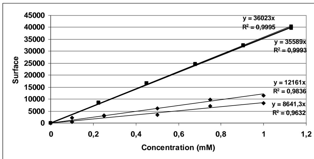
Figure 109 : Comparaison des secondes injections des droites d'étalonnage du AMBA dans l'eau ultra pure (■) et dans la matrice biologique (◆) (séries iii et iv)
