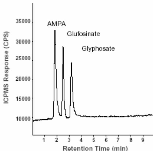
**Figure 50 : Chromatogramme d'un mélange (500 µg/L) d'AMPA, de glufosinate (herbicide phosphoré analogue du glyphosate) et de glyphosate par ICP-MS équipé de cellules de collision (d'après Sadi *et al.*, 2004)**
