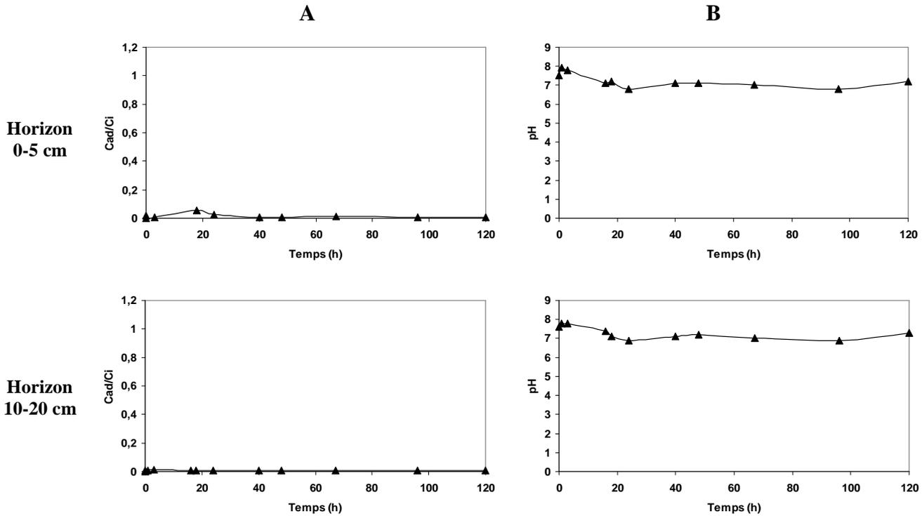
Figure 146 : A. Cinétiques d'adsorption de la mésotrione sur les deux horizons de sol dans le rapport 1/10. B. Suivi du pH du surnageant en fonction du temps.
