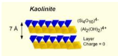
Figure 56 : Structure 1/1 de la kaolinite
