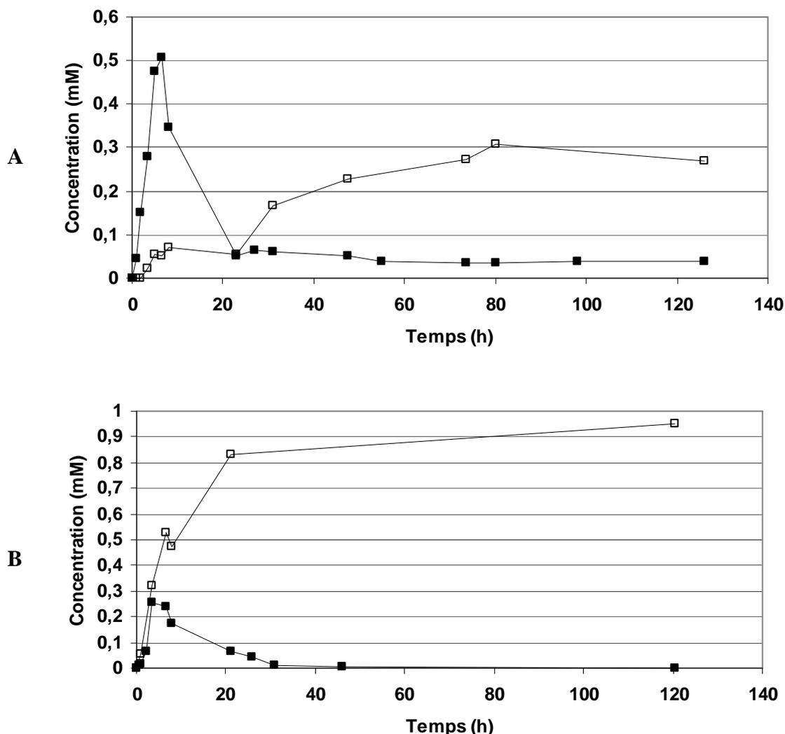
Figure 107 : Cinétiques d'apparition du AMBA (M1) lors de biodégradation de la mésotrione (1 mM (A) et 5 mM (B)) analysées par HPLC (■) et par RMN <sup>1</sup>H (□)
