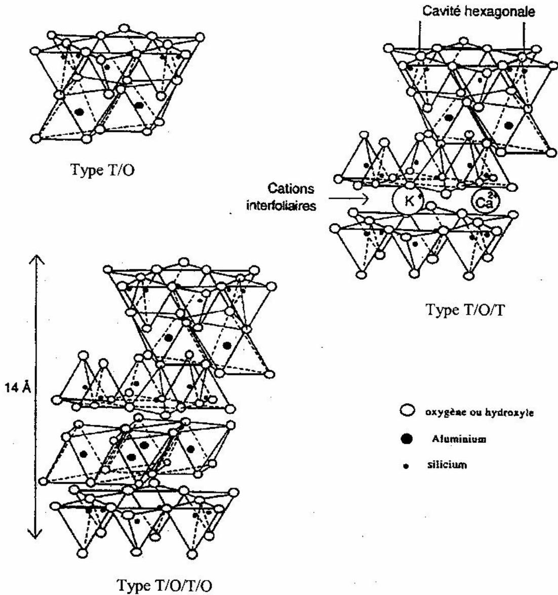
Figure 44 : Structure des argiles cationiques
