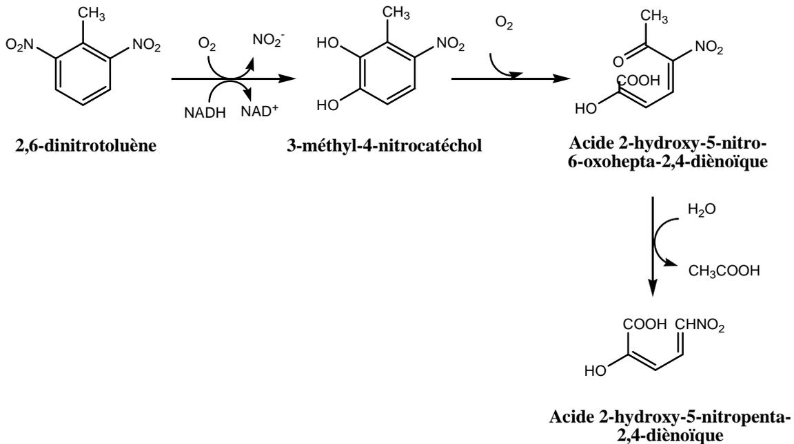
**Figure 27 : Schéma métabolique de biodégradation du 2,6-dinitrotoluène par *Burkholderia cepacia* JS850 et *Hydrogenophaga palleronii* JS863 (Nishino *et al.*, 2000)**
