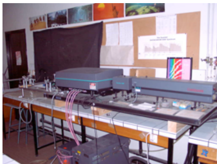
Figure IV.12 : Laser à colorant pompé par un laser YAG:Nd 3+ à impulsions
