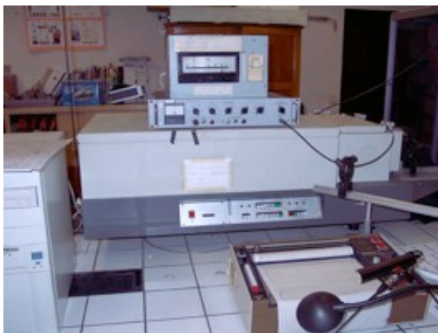
Figure IV.13 : Système d'échantillonnage du signal (BOXCR PAR 162/164)
