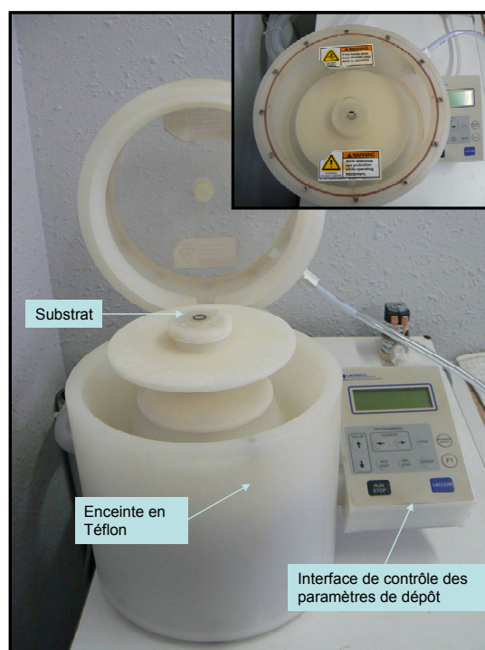
Figure II.26 : Dispositif expérimental utilisé pour les dépôts par « spin-coating »
