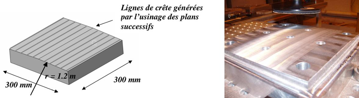
Figure 4.18 : Pièce d'essai des conditions de couplage
