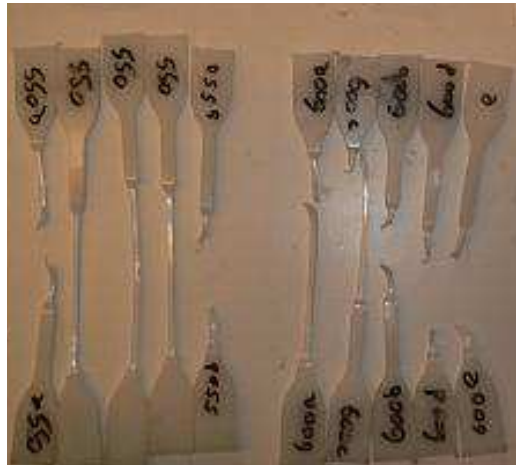
Figure II.12. Exemple d'éprouvettes après l'essai de fatigue.
