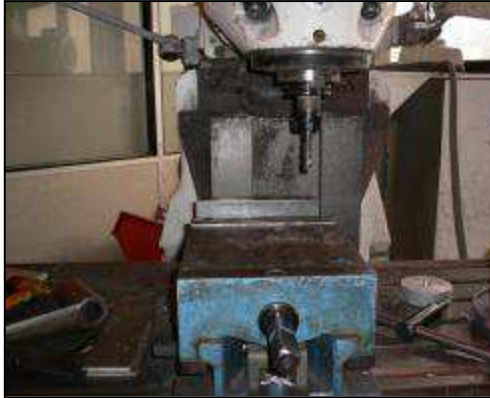
Figure II.3. Centre d'usinage trois axes.
