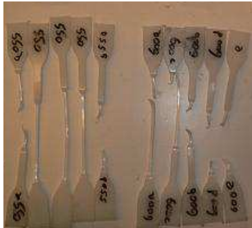
Figure II.12. Exemple d'éprouvettes après l'essai de fatigue.
