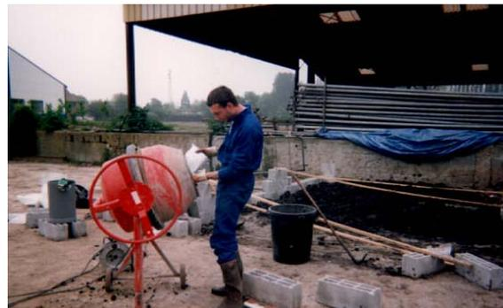
**Photos 2 et 3 :** Tamisage et homogénéisation du sédiment
