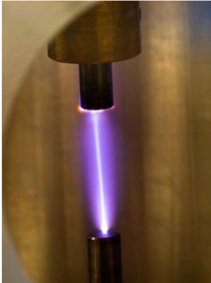
FIGURE 5.17 – Photographie en pause longue d'une transition glow-arc
