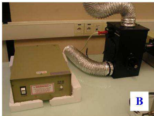
Figure 1 : Vue globale du spectrofluorimètre SLM 8000C Photo A : Module optique avec chambre de mesure, monochromateurs et détecteurs Photo B : Lampe au Xénon et son alimentation Photo C : Modules de commande et Pc
