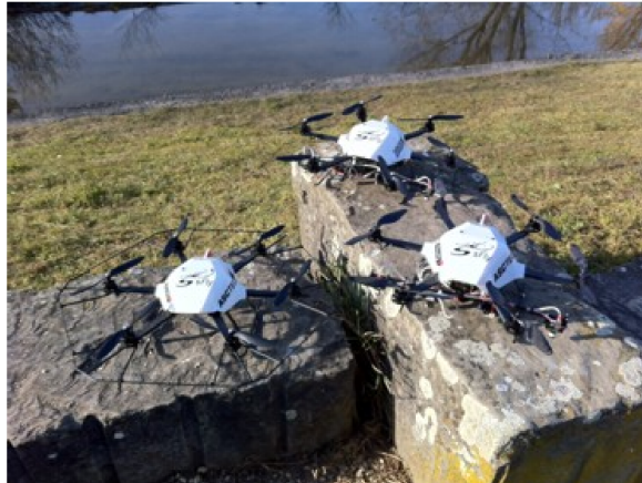
Figure A.2: Trois hexacoopters utilisés pour le projet sFly.
