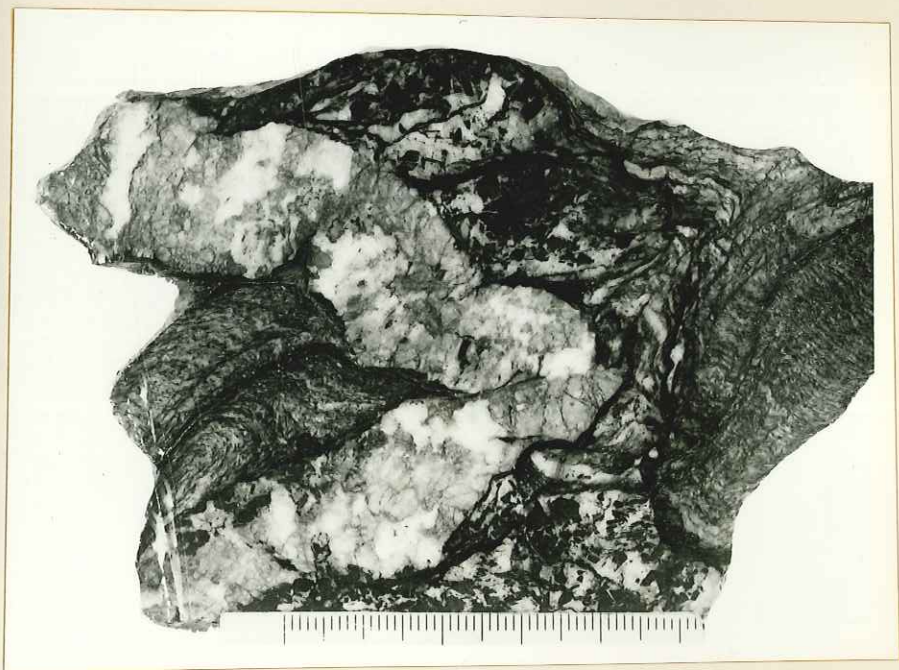
Fig. 46 - Filonnet d'ankérite et sidérose (en noir) plissoté et broyé dans les grès houillers. Plan Raphin.
