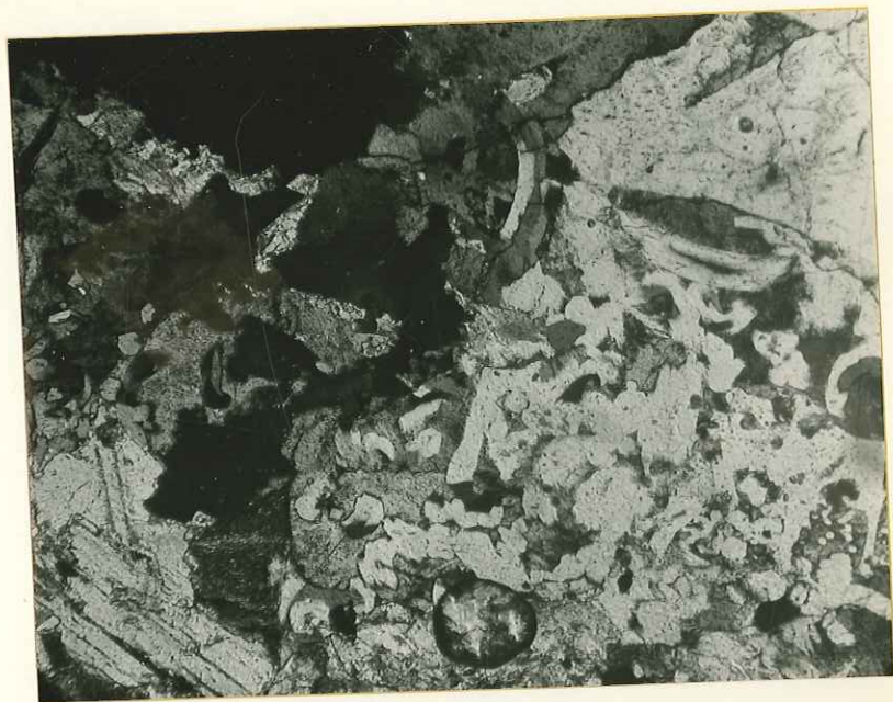
Fig. 83 - Quartz (Q) et albite (Ab) à structure micrographique ; grandes lamelles de micas (M) uniaxe. Filonnet dans les grès du Keuper, sommet Est du Grand Argentier. (x40).
