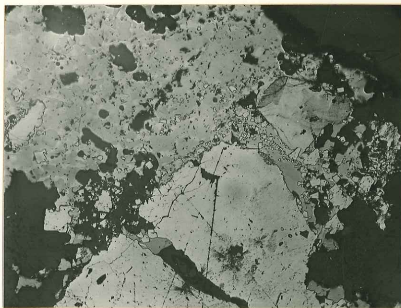
Fig. 66 - Marcassite fibroradiée et en cubes, fracturée et remplacée par quartz, galène, bournonite, cuivre gris. Filon des Herbiers. (x40).
