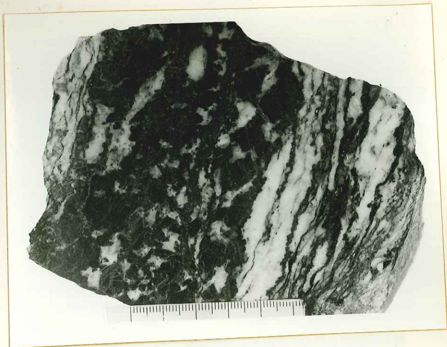
Fig. 71 - Filon de Cornaviaux. Veine riche en blende à gros grain, à veinules de pyrite. Rubanements de quartz, pyrite, galène.
