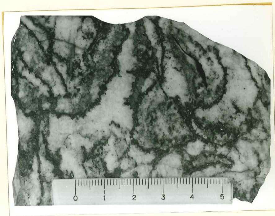
Fig. 72 - Rubanements d'aspect contourné autour de débris d'ankérite ; galène (G), marcasite (M), quartz rosé (Q). Mine de Cornaviaux.
