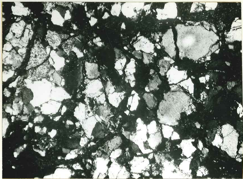
Fig. 21 - Quartzite triasique broyé et injecté d'anhydrite (lamelles sombres). Montagne 1944. Nicols croisés. (x40).
