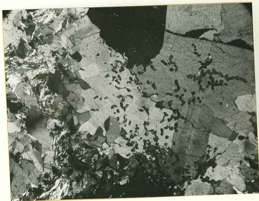
Fig. 81 - Quartz, albite maclée et ripidolite helminthe, lamelles de mica blanc uniaxe, dans un filonnet des schistes houillers. Le Charmaix. Nicols croisés. (x40).
