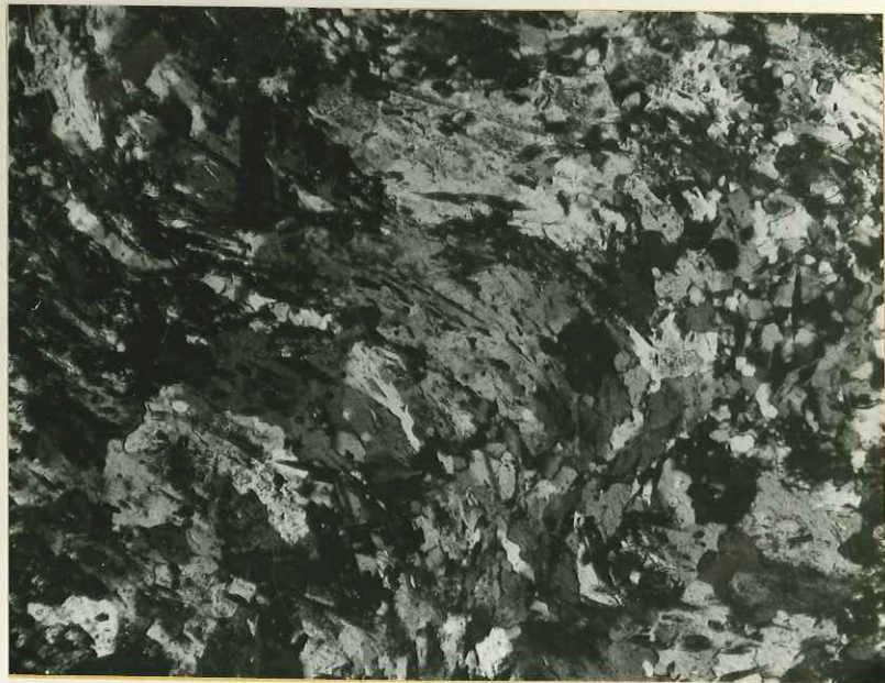
Fig. 29 - Pseudo-entrouques (Col du Fréjus). Résidus de microplis (flancs normaux) nageant dans le fond recristallisé en calcite et quartz, présentant déjà une amorce de foliation soulignée par les trainées sombres charbonneuses. Lumière naturelle. (x16).
