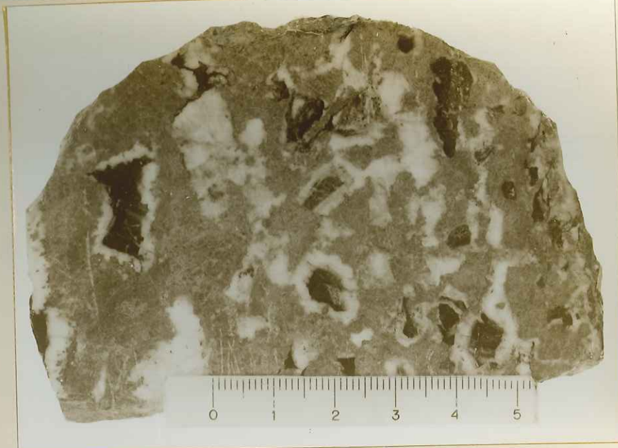
Fig. 51 - Blende à structure en cocardes. Le centre est souvent occupé par un débris de schiste noir cerné d'un liseré de quartz gris-violacé, puis parfois d'un très fin liseré de pyrite, mispickel et galène. Victor Emmanuel, Mine des Sarrazins.
