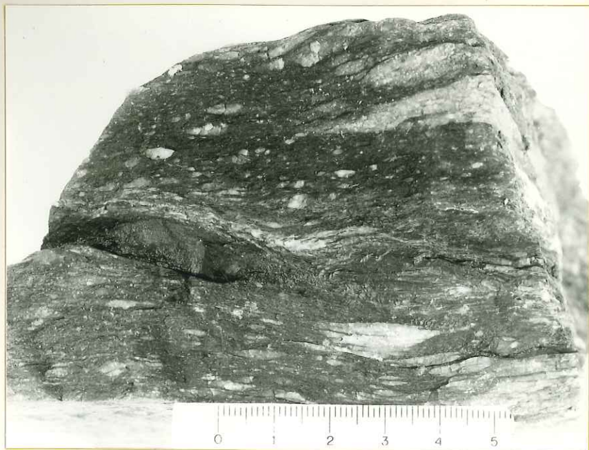
Fig. 12 - Grès laminé vert et violet à passées d'oligiste (Mur stratigraphique de la couche minéralisée du Banchet).
