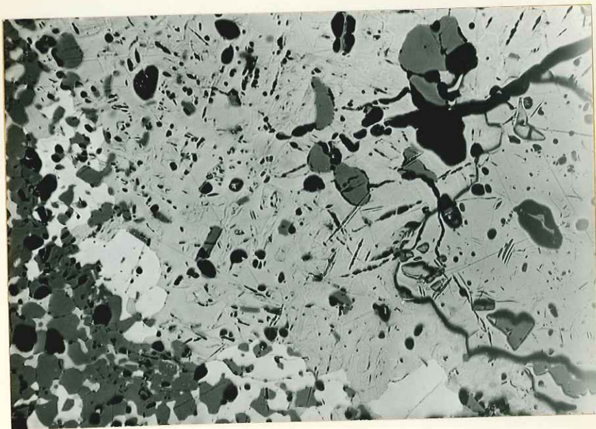
Fig. 56 - Bornite remplacée par covellite (structure graphique). Pyrite (P) et barytine en tâches et cristaux automorphes. Filon supérieur des Sarrazins. (x40).
