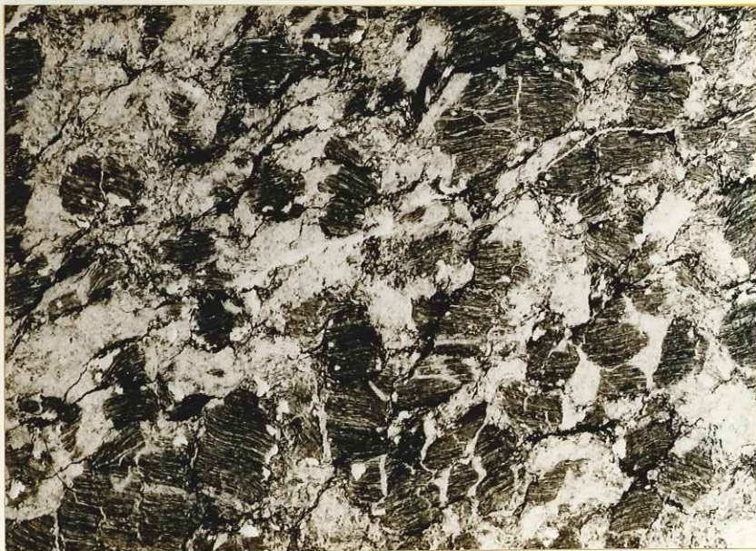
Fig. 28 - Pseudo-entrouques du Col de Fréjus (versant italien) La texture du calcschiste peu déformé a été conservée ; le reste a recristallisé en carbonates, quartz, séricite, et le pigment carboné s'est concentré dans les fissures et les joints de schistosité ici peu développée. Lumière naturelle. (x10).
