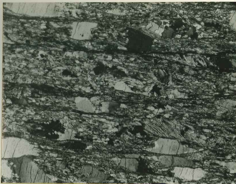
Fig. 8 - Grès houiller laminé (Plan Raphin). Notez la forme fusiforme des grains de quartz craquelés, et la formation d'yeux phylliteux complexes (chlorite, séricite) avec les clivages (001) obliques à la stratification. Nicols croisés. (x40).
