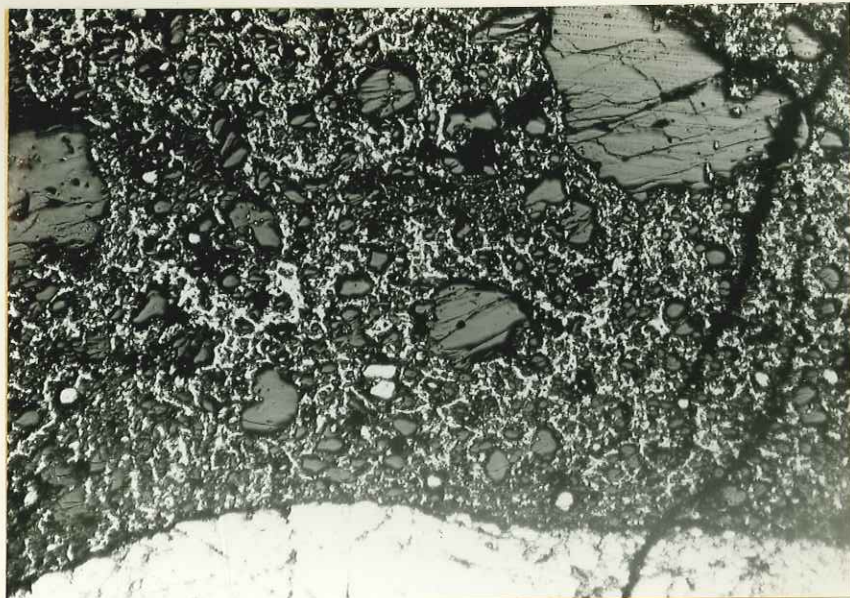
Fig. 63 - Galène et cuivre gris cimentant de la barytine, du quartz broyé et d'anciennes pyrites. Notez la fracture d'âge alpin remplie de quartz laiteux. Filons des Petits Sarrazins. (x40).
