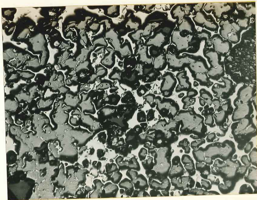
Fig. 54 - Blende recoupée par galène et chalcopyrite. Mine des Sarrazins, Sainte Barbe. (x40).
