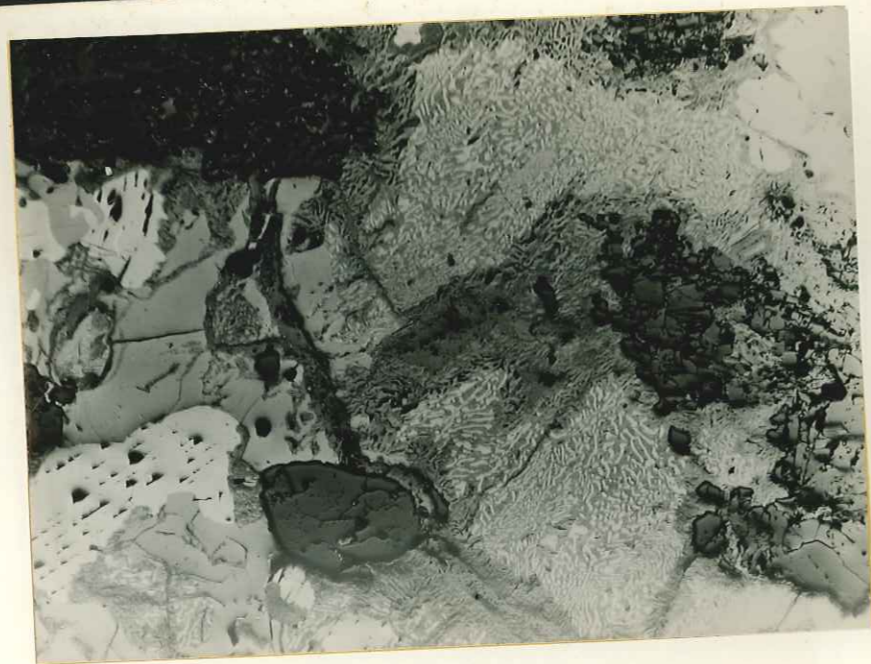
Fig. 59 - Covellite remplaçant la bornite et la galène (structure myrmékitique) ; barytine (en sombre). Filon supérieur des Sarrazins. (x60).
