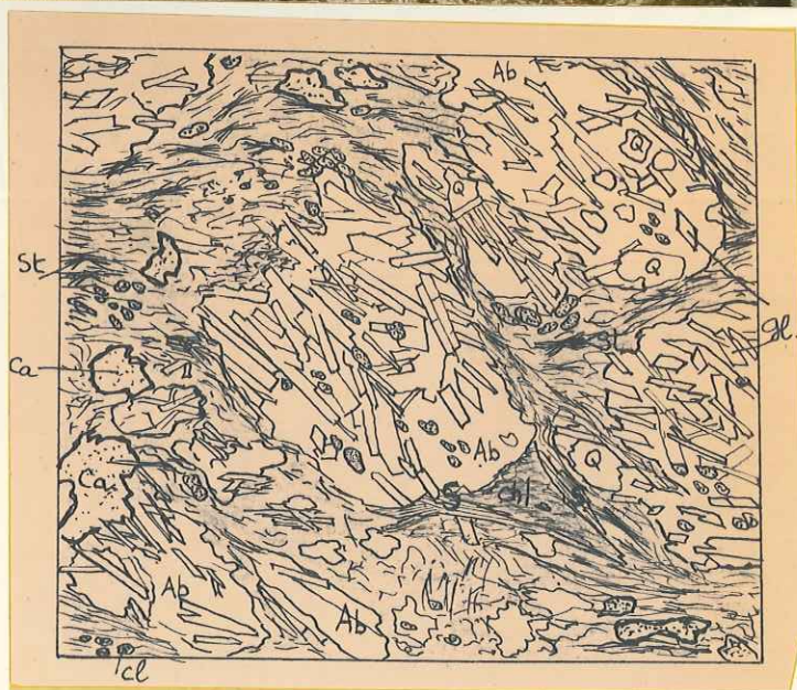
Fig. 16 - Prasinite à glaucophane (route du Replat, Modane). Anciennes albites dans lesquelles la glaucophane (G1) a été conservée ; le fond laminé de la roche est constitué de chlorite (Chl), séricite (s) rare et stilnomélane (st). De nombreux grains de clinozoïsite (cl) sont présents, ainsi que de grandes plages de calcite ; un peu de quartz. Nicols croisés. (x40).
