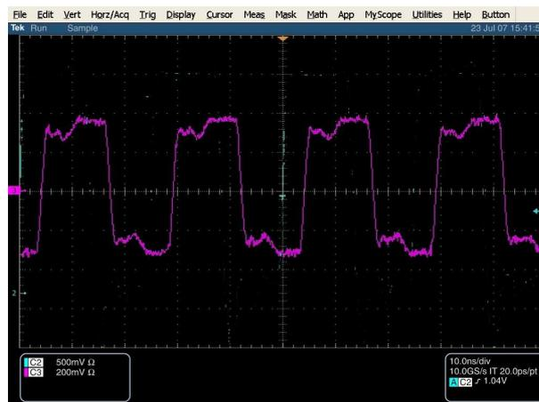
FIG. 5.14 – Mesure de l'horloge différentielle en entrée du FPGA III de traitement.
