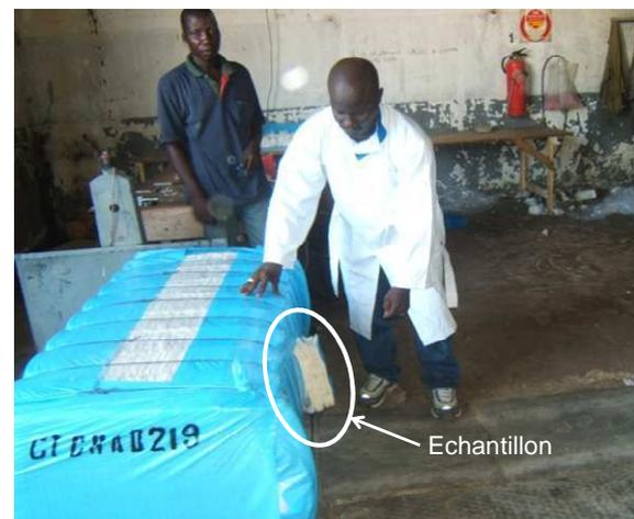
**Figure I-14 : Echantillon prélevé dans une balle suite à son découpage au sabot (d'où le nom d'échantillon au sabot) : L'échantillon au sabot sur une balle à sa sortie de l'usine est situé en bas de la balle (Cliché M. Aboé).**
