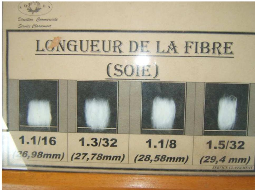
Figure III-5 : Illustration des longueurs de soie obtenue par la méthode du 'pulling'
