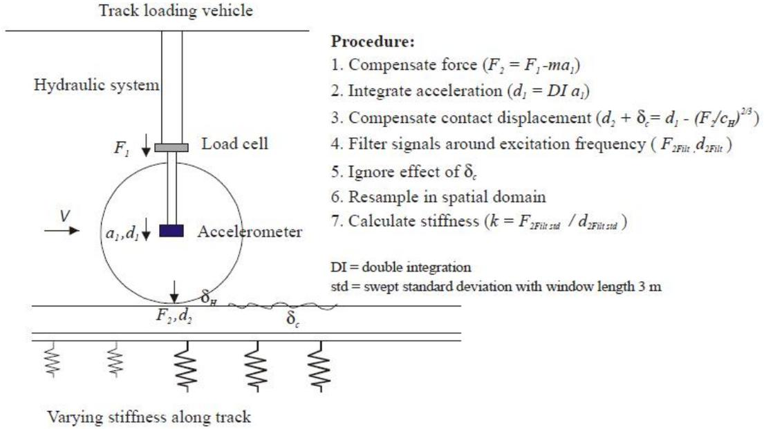
FIGURE 1.6: Principe de la méthode de mesure de rigidité de la voie par RSMV [13].
