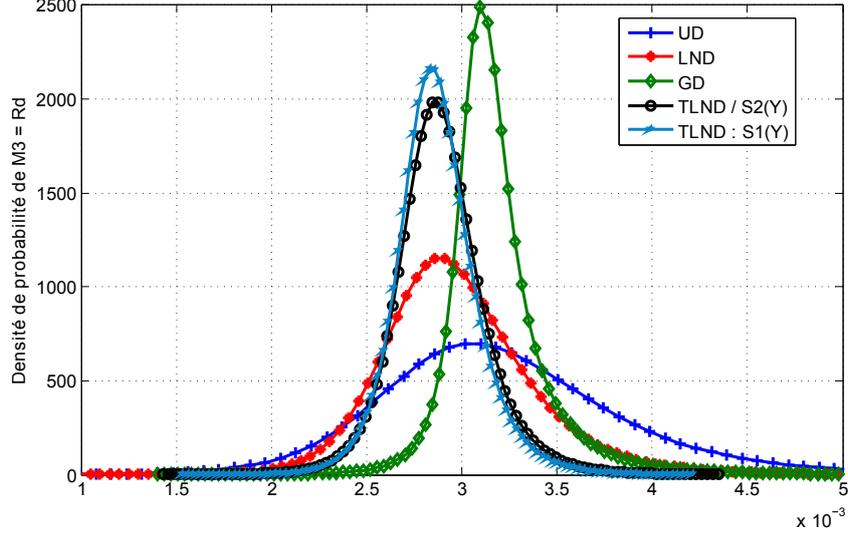
FIGURE 3.9: Distribution de  $M_3 = R_d$  pour les différentes distributions considérées de  $\mathbf{Y}$  : uniforme (UD), Gaussienne (GD), lognormale (LND) et lognormale tronquée avec support  $S_1(Y)$  (TLND/ $S_1(Y)$ ) et avec support  $S_2(Y)$  (TLND/ $S_2(Y)$ ).
