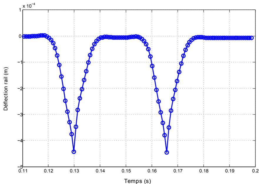
FIGURE 2.16: Déplacements verticaux au niveau du rail.
