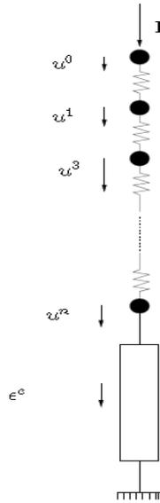
FIGURE 2.4: Schématisation du modèle mixte de Ricci [82].
