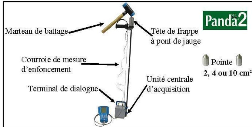
FIGURE 1.13: Principe de fonctionnement du Panda. [42]
