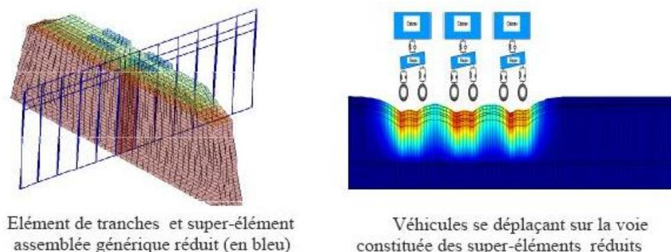
FIGURE 2.2: Principe de modélisation sur Dynavoie [45].
