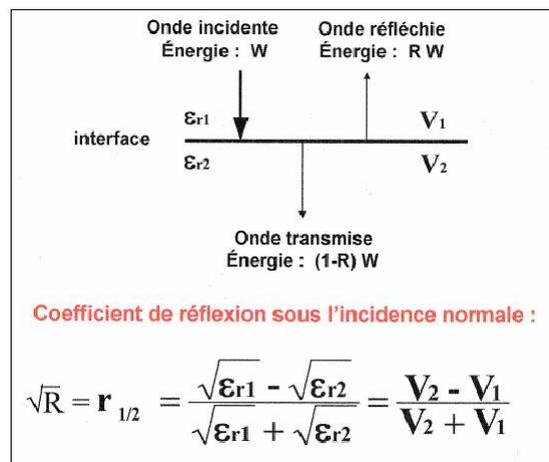
FIGURE 1.11: Coefficient de réflexion des ondes radar [34]
