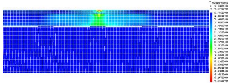
FIGURE 2.14: Contraintes de Von Mises sous charge statique.
