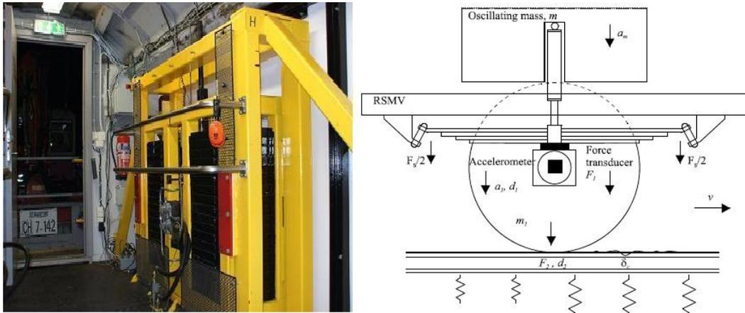
FIGURE 1.5: RSMV et principe de fonctionnement [13].
