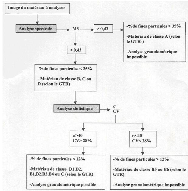
FIGURE 1.15: Démarche complète de l'analyse de texture [22]
