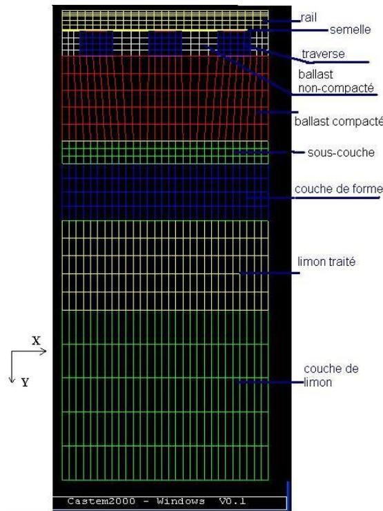
FIGURE 2.5: Maillage d'un modèle à 3 traverses.
