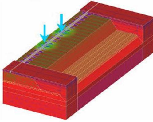
FIGURE 2.3: Exemple de modèle 3D de voie ferrées sur CESAR [27].
