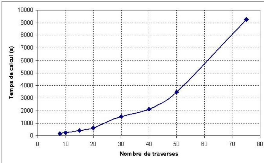
FIGURE 2.21: Evolution des temps de calcul en fonction du nombre de traverses du modèle.
